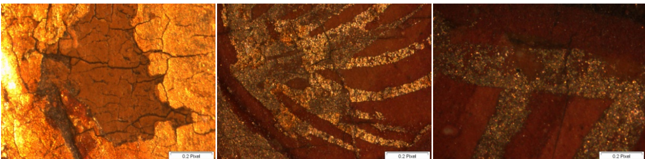
Εικ. 8.62: Υπόστρωμα μεταλλικού φύλλου κάμπου. Εικ. 8.63: Διαφορετικές φάσεις χρυσοκονδυλιών. Εικ. 8.64: Στρώμα κόλλας χρυσοκονδυλιών.
