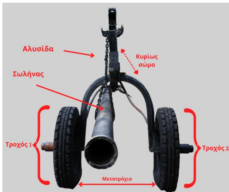
Εικόνα 52 Βασικά μέρη, Τροχήλατο όχημα μεταφοράς αγωγών, πηγή: ©Μουσείο Λίμνης Μαραθώνα, Εργαστήριο Συντήρησης Μεταλλικών Αντικειμένων, ΠΑ.Δ.Α. (Δημήτριος Τράκας)
