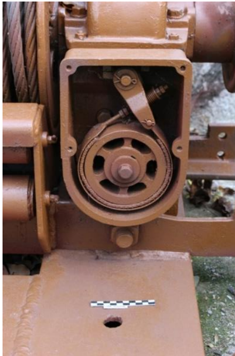
Εικόνα 21: Φρένο έλξης, πηγή: ©Μουσείο Λίμνης Μαραθώνα, Εργαστήριο Συντήρησης Μεταλλικών Αντικειμένων, ΠΑ.Δ.Α. (Δημήτριος Τράκας)
