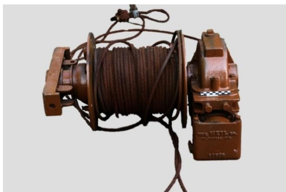
Εικόνα 22: Μικρού μεγέθους βαρούλκο, πηγή: ©Μουσείο Λίμνης Μαραθώνα, Εργαστήριο Συντήρησης Μεταλλικών Αντικειμένων, ΠΑ.Δ.Α. (Δημήτριος Τράκας)
