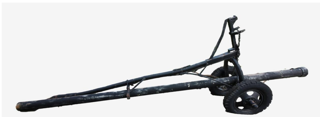
Εικόνα 17 : Τροχήλατο εξάρτημα μεταφοράς αγωγών, πηγή: ©Μουσείο Λίμνης Μαραθώνα, Εργαστήριο Συντήρησης Μεταλλικών Αντικειμένων, ΠΑ.Δ.Α. (Δημήτριος Τράκας)
