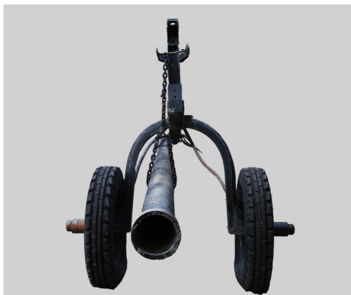
Εικόνα 53 Τροχήλατο όχημα μεταφοράς αγωγών, πηγή: ©Μουσείο Λίμνης Μαραθώνα, Εργαστήριο Συντήρησης Μεταλλικών Αντικειμένων, ΠΑ.Δ.Α. (Δημήτριος Τράκας)
