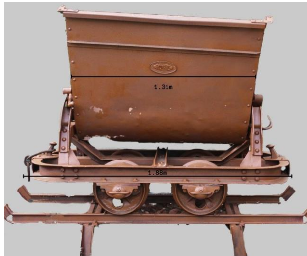
Εικόνα 42 Διαστάσεις Τροχήλατου βαγονέτου σε τμήμα ραγών, πηγή: ©Μουσείο Λίμνης Μαραθώνα, Εργαστήριο Συντήρησης Μεταλλικών Αντικειμένων, ΠΑ.Δ.Α. (Δημήτριος Τράκας)
