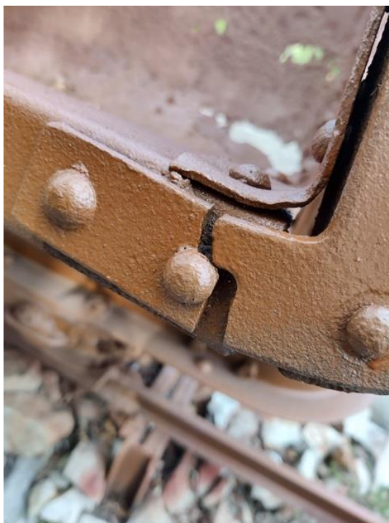
Εικόνα 63 Σημείο θραύσης, πηγή: ©Μουσείο Λίμνης Μαραθώνα, Εργαστήριο Συντήρησης Μεταλλικών Αντικειμένων, ΠΑ.Δ.Α. (Δημήτριος Τράκας)
