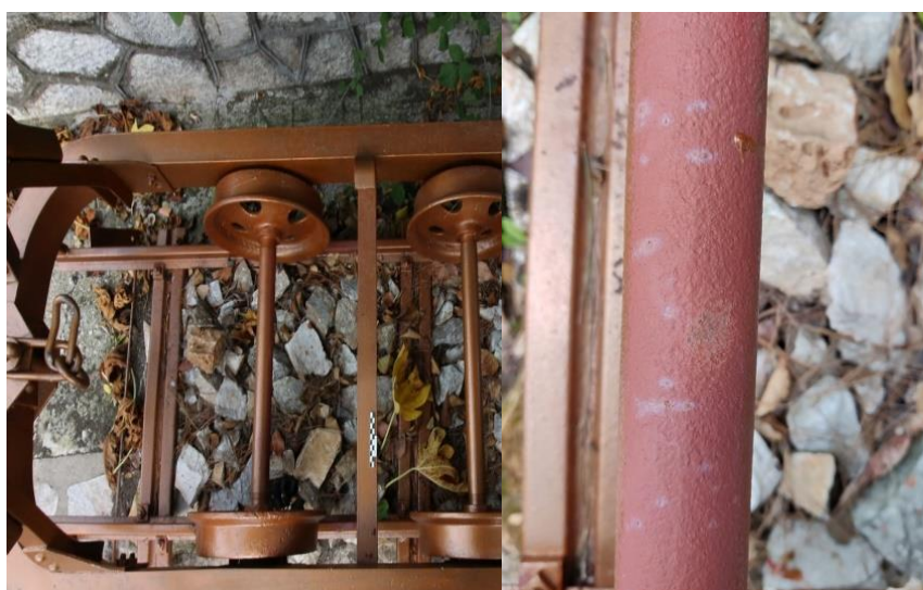
Εικόνα 66 Χρωματική αλλοίωση της χρωματικής επέμβασης πηγή: ©Μουσείο Λίμνης Μαραθώνα, Εργαστήριο Συντήρησης Μεταλλικών Αντικειμένων, ΠΑ.Δ.Α. (Δημήτριος Τράκας)
