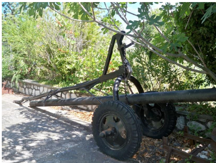
Εικόνα 16: Τροχήλατο εξάρτημα μεταφοράς αγωγών, πηγή: ©Μουσείο Λίμνης Μαραθώνα, Εργαστήριο Συντήρησης Μεταλλικών Αντικειμένων, ΠΑ.Δ.Α. (Δημήτριος Τράκας)
