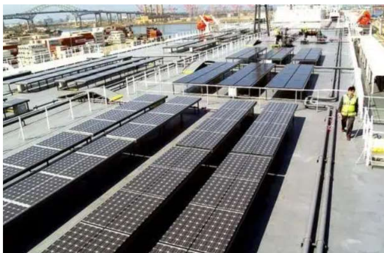
ΕΙΚΟΝΑ 2-7: Φωτοβολταϊκό σύστημα του Auriga Leader Ship. Πηγή: ( https://www.marineinsight.com/types-of-ships , 2022)
