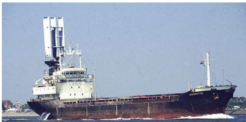
ΕΙΚΟΝΑ 2-15: Σύστημα Walker Wingsail στο Ashington Ship.
