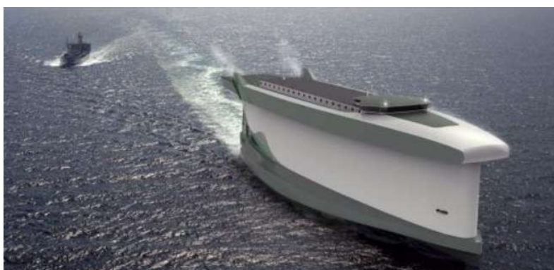
ΕΙΚΟΝΑ 2-16: Vindskip - Το πρώτο cargo ship που κινείται με αιολική ενέργεια.
