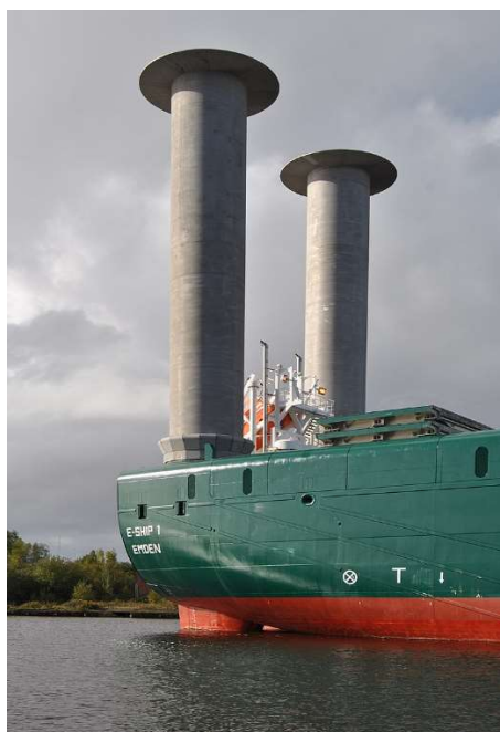
ΕΙΚΟΝΑ 2-18: Rotor Ship – Σύστημα Flettner.
