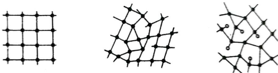
ΕΙΚΟΝΑ 3-38: Σχηματική αναπαράσταση της δομής πυριτίου, α) Κρυσταλλικό πυρίτιο,
