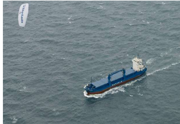
EIKONA 2-20: Πρόωση πλοίου με ιστίο τύπου Kite. Πηγή: (SkySails, 2020)
