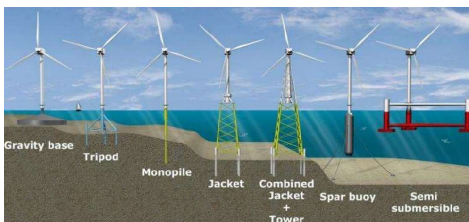
ΕΙΚΟΝΑ 2-24: Είδη ανεμογεννητριών στο υδάτινο περιβάλλον για διάφορα βάθη. Πηγή: (Ρώσσης). Ανακτήθηκε: ( http://www.cres.gr , 06.07.22)
