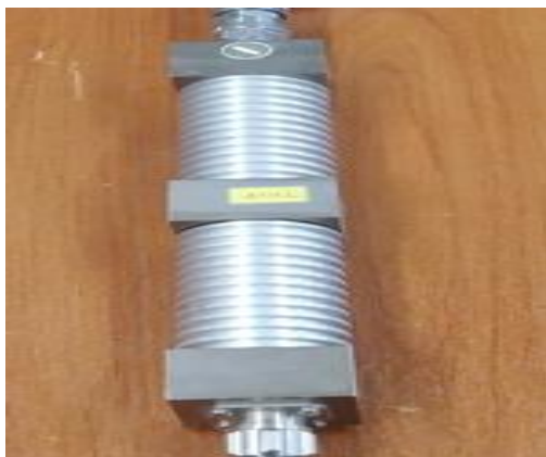
Εικόνα 3.7 -Φίλτρο HD 30267-A με ζώνη διέλευσης 1,5 - 2,5 GHz
