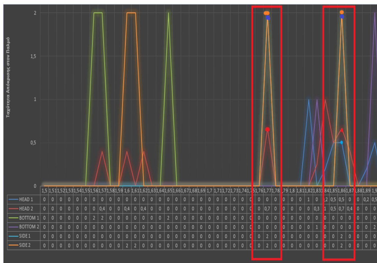
Εικόνα 4.29 - Απόκριση του drone Quantum Nova Προστην έκθεση του σε Ηλεκτρομαγνητικό Παλμό συχνότητας 1,77 και 1,86 GHz
