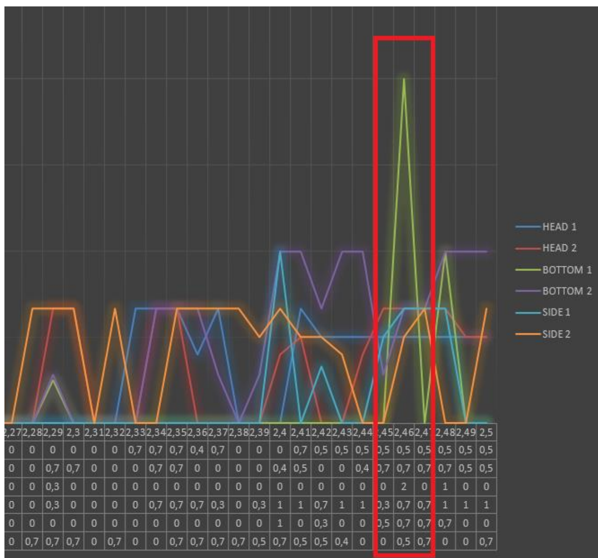
Εικόνα 4.31 - Απόκριση του drone Quantum Nova Pro στην έκθεση του σε Ηλεκτρομαγνητικό Παλμό στη συχνότητα 2,46 GHz
