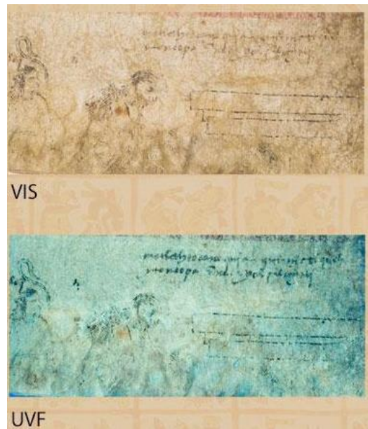
Εικόνα 4.5.6 Με το UVF μπορούμε να διαβάσουμε τις επιγραφές στο έργο τέχνης σε χαρτί (accessed 3/9/2021, < https://www.mexicolore.co.uk/aztecs/writing/hi-tech-imaging-of-aztec-codices-in-paris >).
