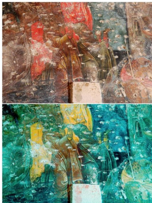
Εικόνα 6.5.5 Στην Ιερή Μονή Ταξιαρχών του Οσίου, έγινε φωτογράφιση με υπέρυθρη φωτογραφική για τα πραγματοποιηθεί ταυτοποίηση χρωστικών, Μουσείο Μπενάκη Αθήνα (accessed 9/8/2021, < https://benakiconservation.com/2015/11/ >).
