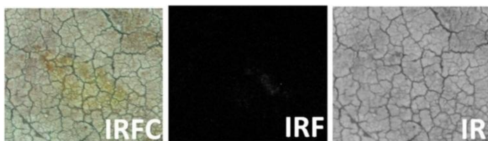
Εικόνα 9.3.2 Μπορεί να γίνει αναγνώριση των χρωστικών χρησιμοποιώντας αυτές τις τρεις μεθόδους (accessed 6/9/2021, < heritagesciencejournal.springeropen.com/articles/ >).
