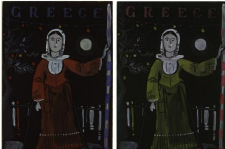
Εικόνα 6.5.1 Αριστερά βλέπουμε το έργο υπό φωτογράφιση στο ορατό ενώ δεξιά βλέπουμε το αποτέλεσμα της φωτογράφισης στην έγχρωμη υπέρυθρη απεικόνιση. Λόγω του ομοιόμορφου φθορισμού στις ίδιες χρωματικές επιφάνειες συμπεραίνουμε ότι το έργο δεν έχει υποστεί μεταγενέστερες χρωματικές επεμβάσεις (accessed 10/1/2022, P. Banou, A. Alexoroulou, A. Kaminari, 2019, "PHOTOGRAPHIC AND TECHNICAL EXAMINATION: A VALUABLE TOOL FOR THE CONSERVATION TREATMENT OF WORKS OF ART ON PAPER AND PARCHMENT", In book: Works of Art on Parchment and Paper: Interdisciplinary Approaches, Publisher: Znanstvena založba Filozofske fakultete Univerze v Ljubljani (Ljubljana University Press, Faculty of Arts) and Arhiv Republike Slovenije (The Archives of the Republic of Slovenia).
