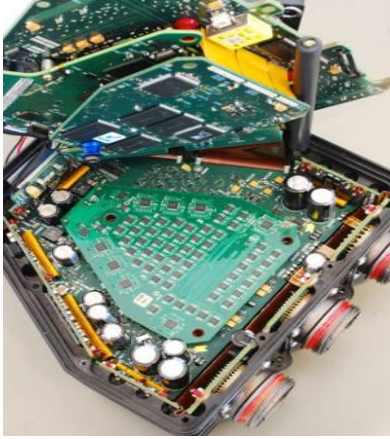
Σχήμα 4.10: Το εσωτερικό της μονάδας ελέγχου κινητήρα
