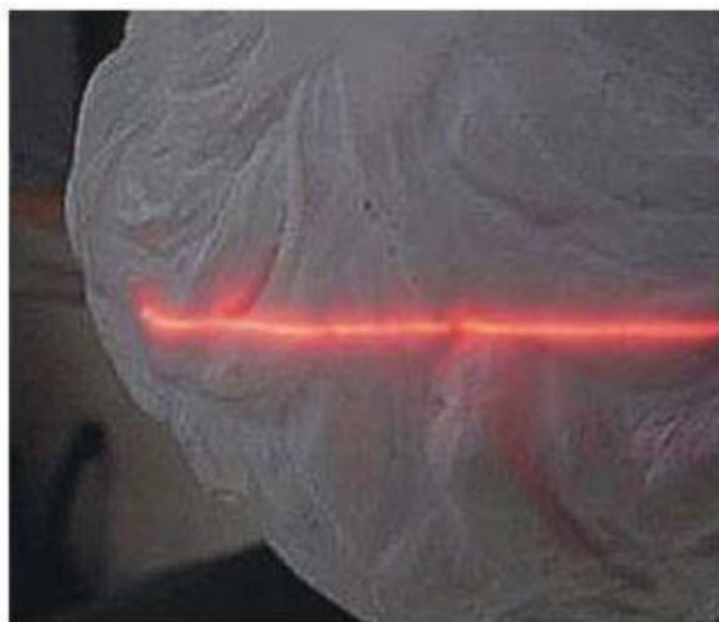
Εικόνα 44 Παράδειγμα ακτίνας λέιζερ εκτός εστίασης λόγω της λανθασμένης απόστασης από το αντικείμενο (FARIN, 1993).
