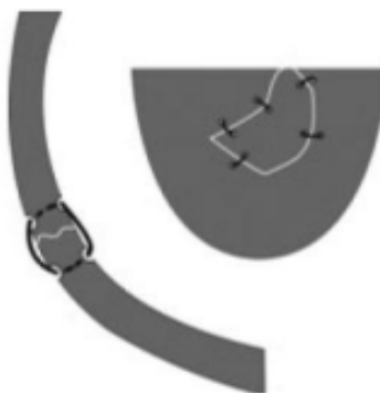
Εικόνα 3 Σχηματική αναπαράσταση της πρώτης μεθόδου σύνδεσης θραυσμάτων με τρύπες, που συνδέονται με δερμάτινο σχοινί ή κορδόνι. (Dooijes R., 2007)
