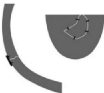
Εικόνα 5 Σχηματική αναπαράσταση τεχνικής στην οποία τοποθετούνται σύνδεσμοι μόλυβου σε σχήμα Π (Dooijes R., 2007).
