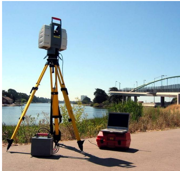
Εικόνα 41 Ανέπαφος σαρωτής τριών διαστάσεων. (πηγή)
