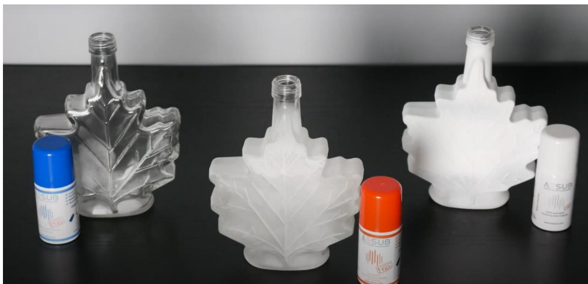
Εικόνα 75 Παρουσίαση γυάλινου βάζου πριν και μετά την επικάλυψη του «AESUB Blue 3D Scan Spray». Αριστερά παρατηρούμε την υφή την επιφάνειας πριν την εφαρμογή και δεξιά μετά την εφαρμογή(πηγή).
