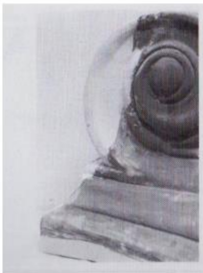
Εικόνα 20 Τελικό αποτέλεσμα, έπειτα από τη χύτευση γύψου στο καλούπι σιλικόνης (Λαμπρόπουλος, 1996).
