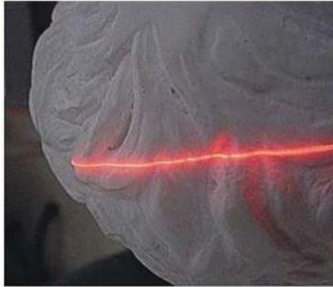
Εικόνα 45 Σωστή ρύθμιση της εστίασης της δέσμης λέιζερ στο αντικείμενο επιτυγχάνοντας την μέγιστη ανάλυση (FARIN, 1993).
