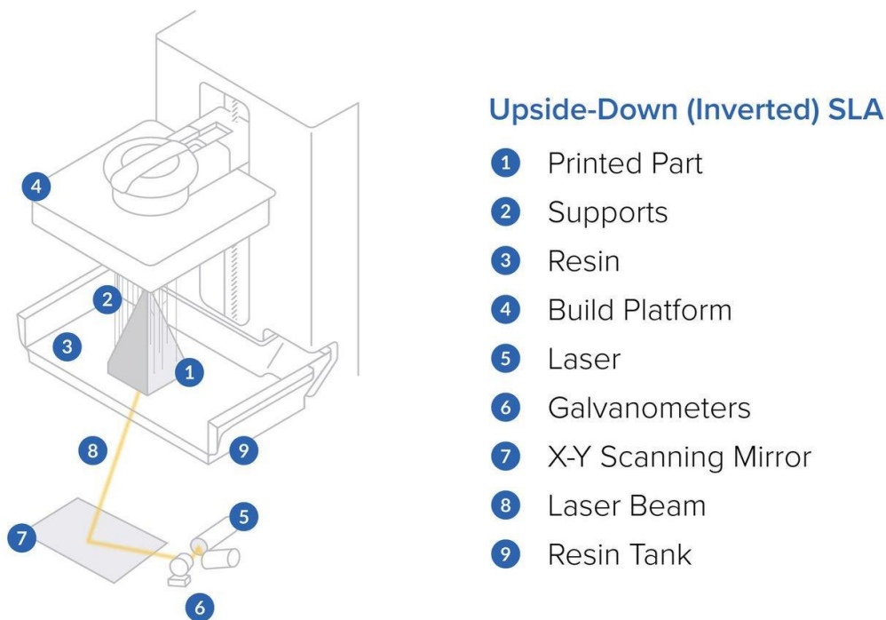
Εικόνα 59 Μια γραφική αναπαράσταση της βασικής λειτουργίας της στερεολιθογραφίας (SLA) στην τρισδιάστατη εκτύπωση.
