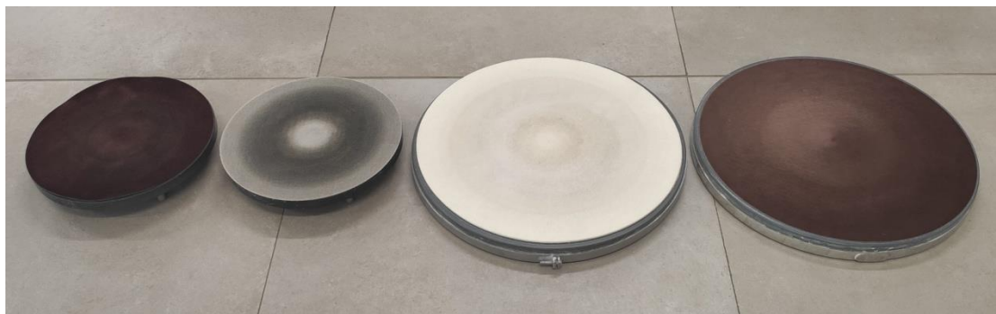
Εικόνα 9.5: Λειαντικοί δίσκοι που χρησιμοποιήθηκαν, τραχύτητας 6μm 3μm 1μm 0.25μm (αντίστοιχα από αριστερά προς τα δεξιά).
