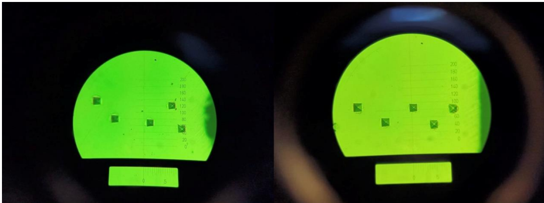
Εικόνα 10.1: Αποτυπώματα δοκιμίου IIIA (αριστερά), αποτυπώματα δοκιμίου IIIB (δεξιά).
