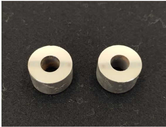
Εικόνα 9.6: Δοκίμια IIIA και IIIB αμέσως μετά την ολοκλήρωση της στίλβωσης.
