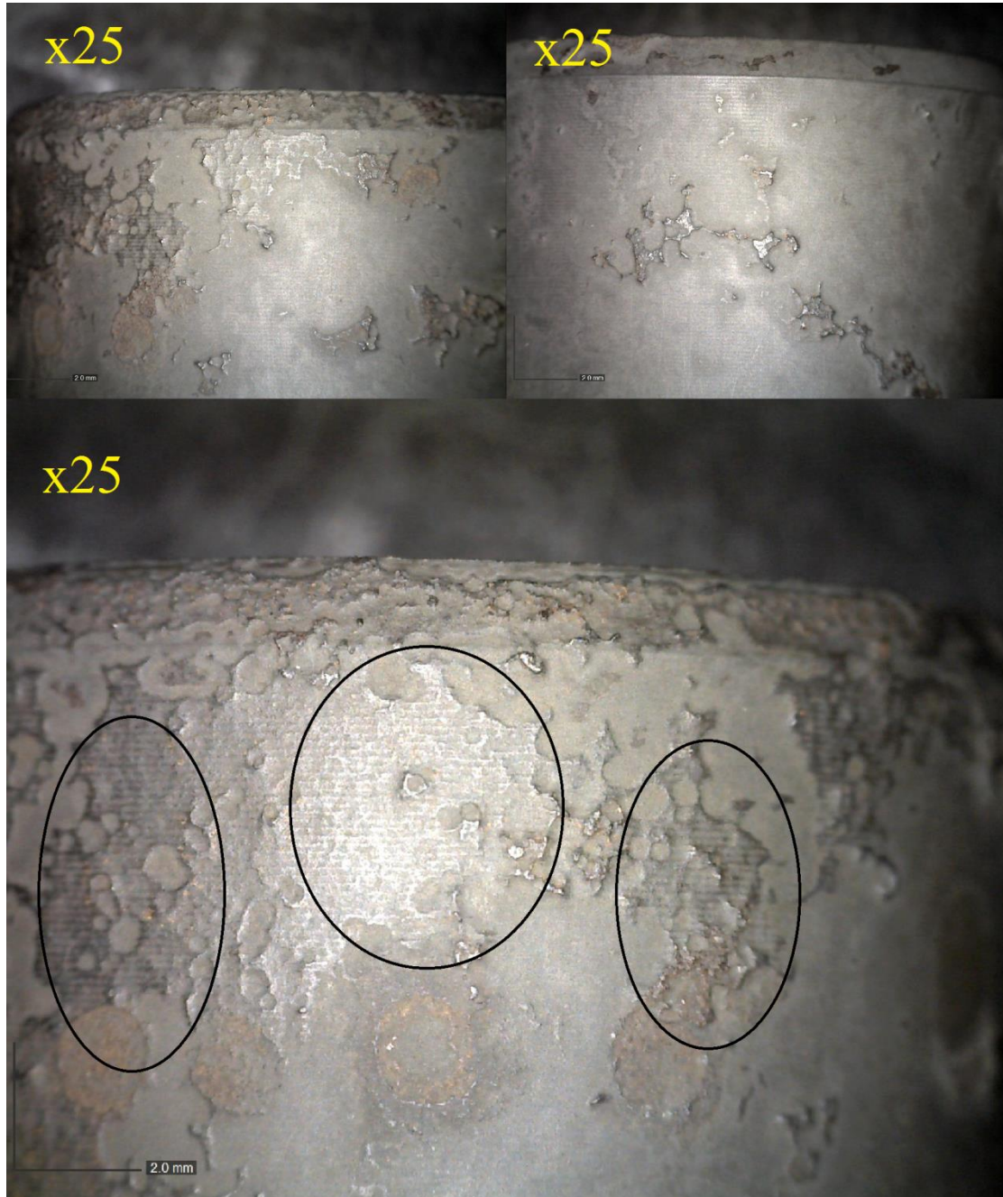
Εικόνα 7.4: Δοκίμιο ΙΙΙ, απεικόνιση εξογκωμάτων με εμφανή σημάδια μηχανουργικής κατεργασίας σε μεγέθυνση x25.
