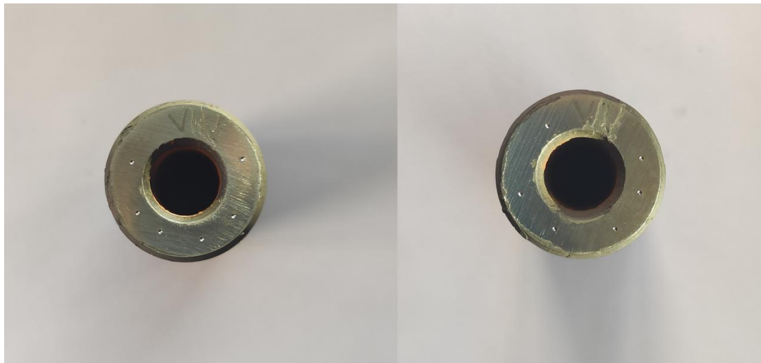
Εικόνα 8.2: Δοκίμιο III (αριστερά), δοκίμιο IV (δεξιά) μετά την δοκιμή σκληρομέτρησης.
