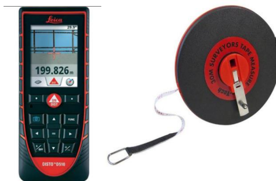
Εικόνα 17. Απλά όργανα μετρήσεων : αποστασιόμετρο laser και μετροταινία [41]
