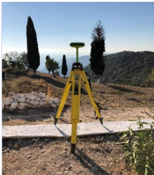
Εικόνα 41. Ίδρυση κορυφών δικτύου με δορυφορικές παρατηρήσεις
