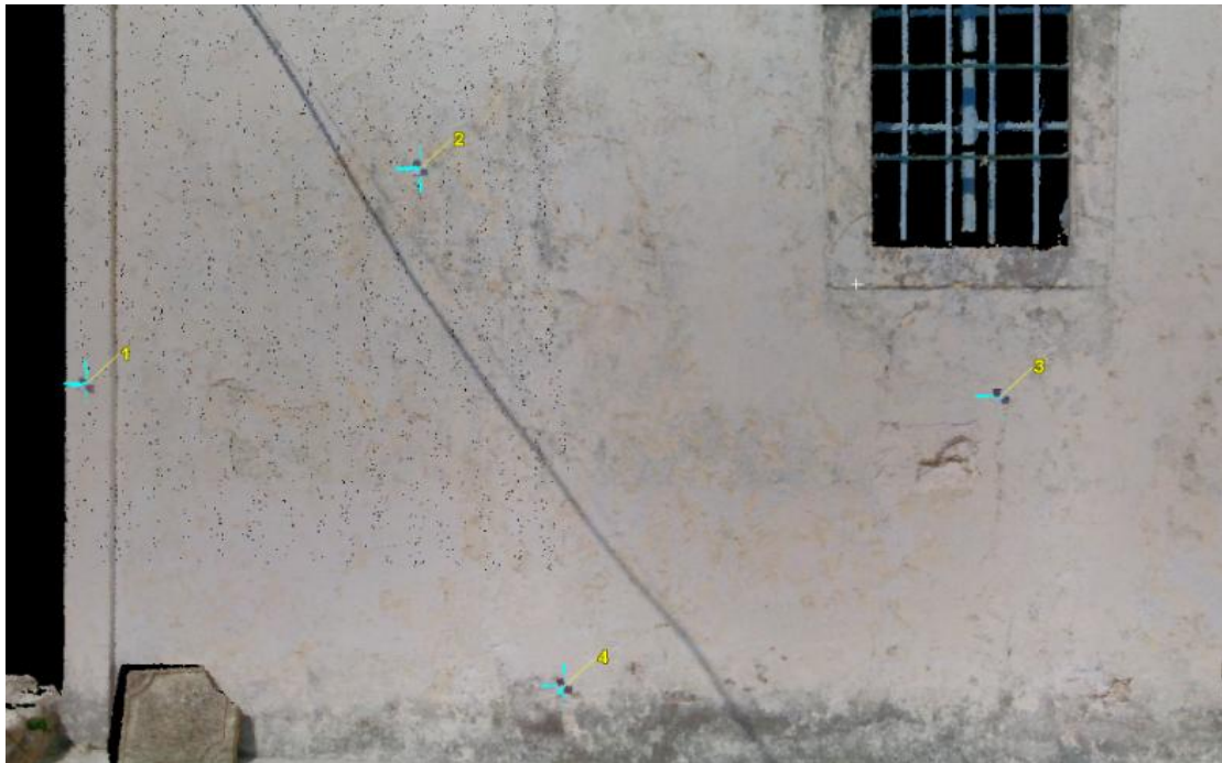
Εικόνα 52. Στιγμιότυπο κατά την διαδικασία ορισμού των ειδικών στόχων που δεν αναγνωρίστηκαν αυτόματα από το λογισμικό
