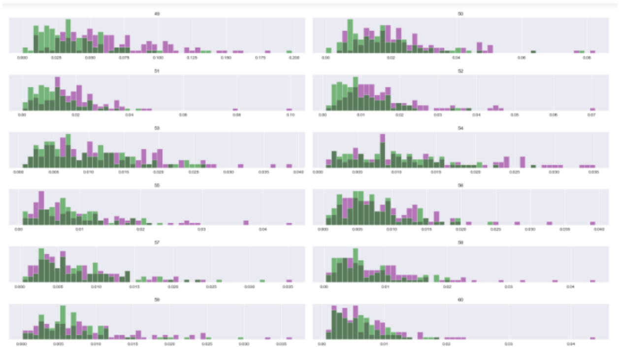
Εικόνα 15. Σχέση ισχύς σήματος και συχνότητας μεταξύ μεταλλικής επιφάνειας και βράχου σε κάθε χαρακτηριστικό (feature)
