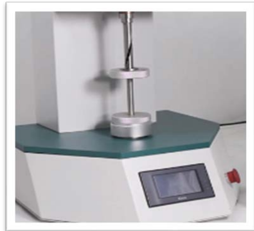
Σχήμα 58: Κλίμακας διαβαθμίσεις τσαλακώματος AATCC & Αυτόματο Wrinkle Recovery Tester AATCC (41)
