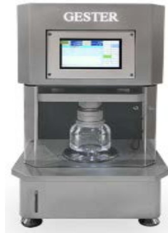
Σχήμα 45: Γραφικά η Αντοχή στη διάρρηξη & όργανο δοκιμής διογκωμένο διάφραγμα (29)
