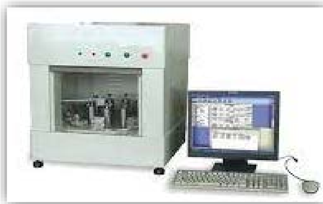
Σχήμα 59: Ψηφιακός AATCC 66 ελεγκτής επαναφοράς γωνίας Fabric Crease Recovery Tester (41)
