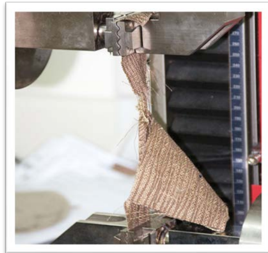
Σχήμα 44: BND-YG065C ψηφιακός ελεγκτής αντοχής εφελκυσμού & μια δοκιμή
