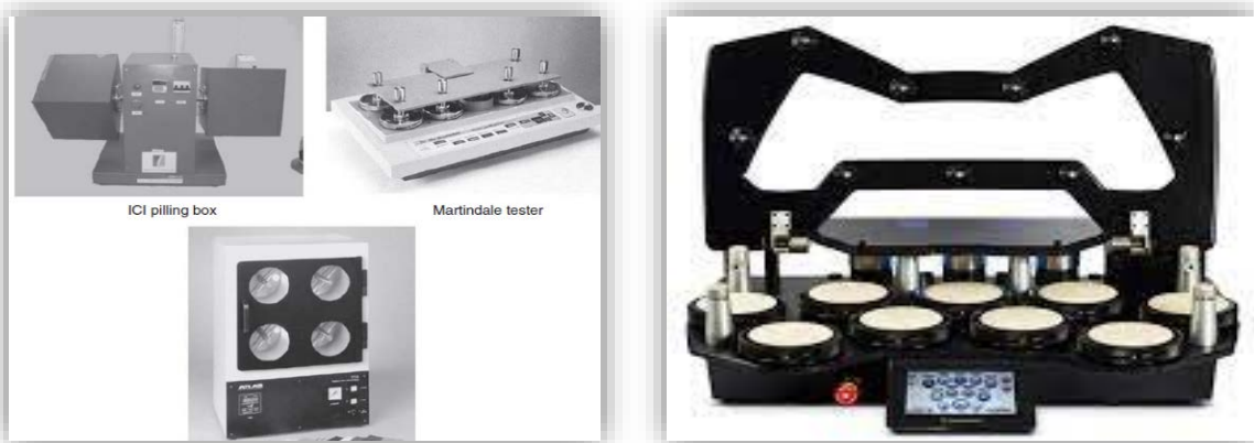
Σχήμα 57: Ελεγκτής κιβωτίων της ICI, ελεγκτής Martindale και Atlas & Martindale wise tach tm
