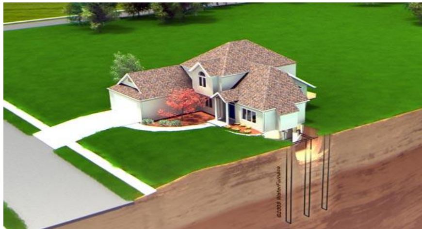
Εικόνα 49 Κατακόρυφο γεωθερμικό κύκλωμα
