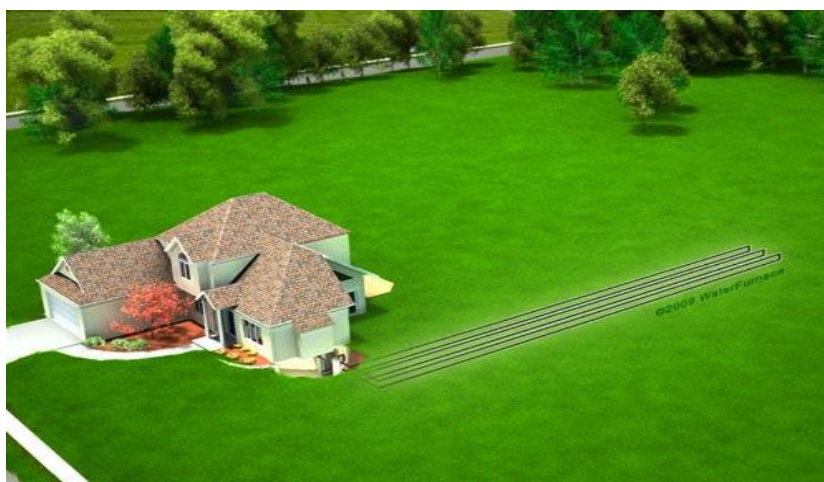
Εικόνα 48 Οριζόντιο γεωθερμικό κύκλωμα (πηγή: https://www.eneroots.gr )
