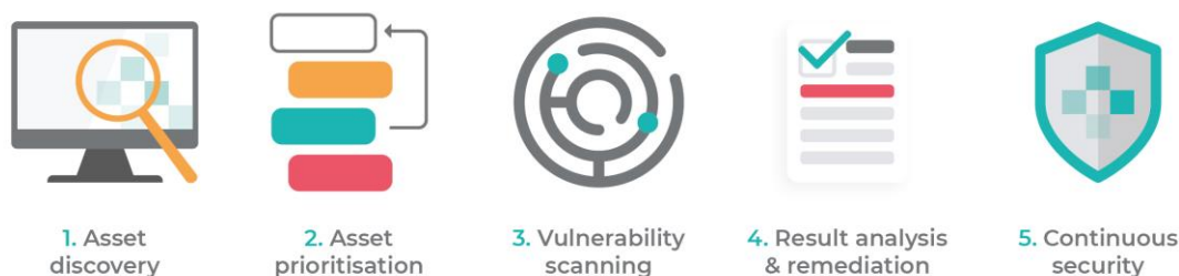
Εικόνα 13: Κύκλος ζωής ενός Vulnerability assessment.
