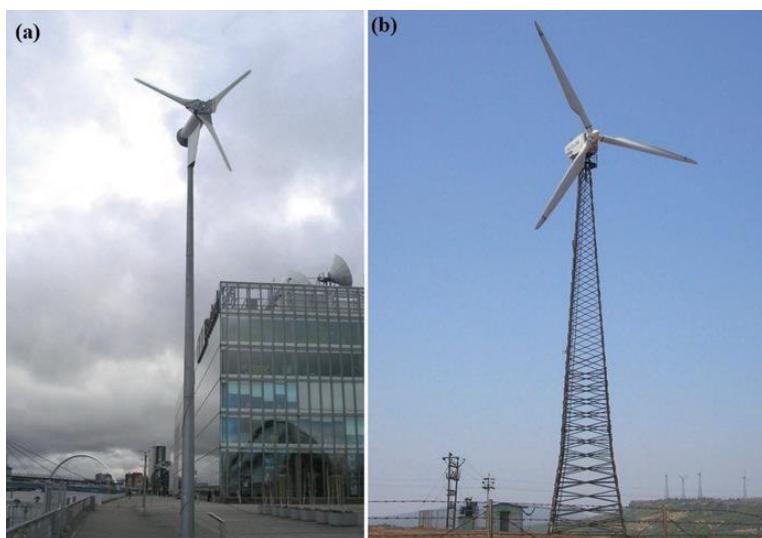
Εικόνα 43. Ανεμογεννήτριες οριζοντίου άξονα. Πηγή: Roy and Bandyopadhyay - 2019 - Wind Power Based Isolated Energy Systems.pdf'.
