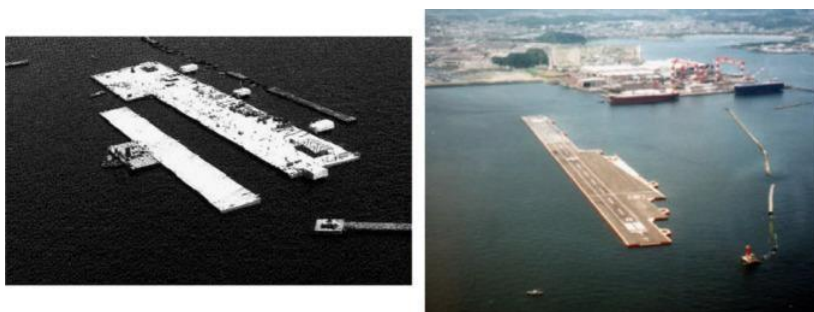
Εικόνα 54. Συναρμολόγηση πλωτής κατασκευής. Πηγή: A review of Very Large Floating Structures (VLFS) for coastal and offshore uses, 2015, σελίδα 5.
