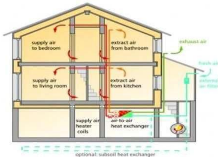
Εικόνα 2.8) Απογωγή-προσαγωγή αέρα μέσω μηχανικού αερισμού
