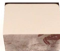
Εικόνα 5.3.6 α: Δοκίμιο Orvar Supreme από την πρώτη σειρά μετά από λείανση και στίλβωση
