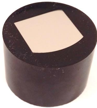
Εικόνα 5.3.1 β: Δοκίμιο Calmax μετά από εγκιβωτισμό, λείανση και στίλβωση
