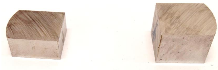
Εικόνα 5.1.1 β: Δοκίμια Calmax μετά την κοπή
