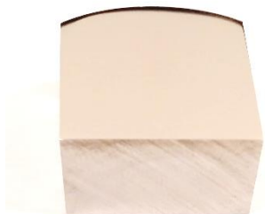
Εικόνα 5.3.1 α: Δοκίμιο Calmax από την πρώτη σειρά μετά από λείανση και στίλβωση
