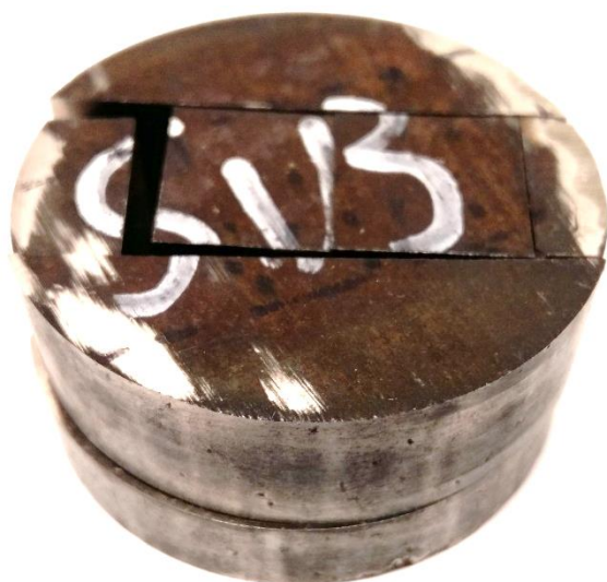
Εικόνα 5.1.5 α: Δοκίμα Sverker 3 μετά την κοπή
