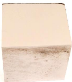
Εικόνα 5.3.5 α: Δοκίμιο Sverker 3 από την πρώτη σειρά μετά από λείανση και στίλβωση
