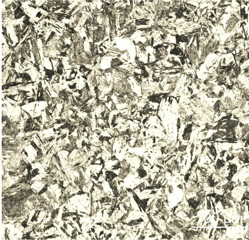
Εικόνα 8.2.3.1: Μικροδομή δοκμίου Nimax μετά από λείανση, στίβωση και χημική προσβολή. Μεγέθυνση \times 200 .
