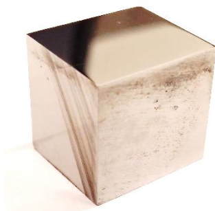
Εικόνα 5.3.3 α: Δοκίμιο Nimax από την πρώτη σειρά μετά από λείανση και στίλβωση
