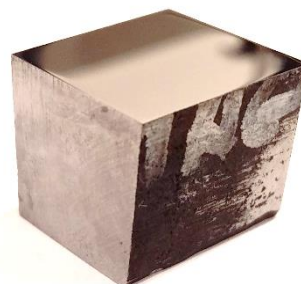
Εικόνα 5.3.4 α: Δοκίμιο Viking από την πρώτη σειρά μετά από λείανση και στίλβωση
