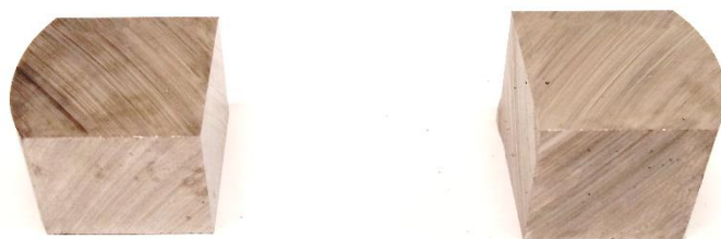
Εικόνα 5.1.2 β: Δοκίμια Unimax μετά την κοπή
