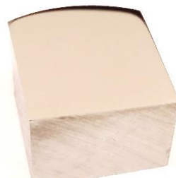
Εικόνα 5.3.2 α: Δοκίμιο Unimax από την πρώτη σειρά μετά από λείανση και στίλβωση
