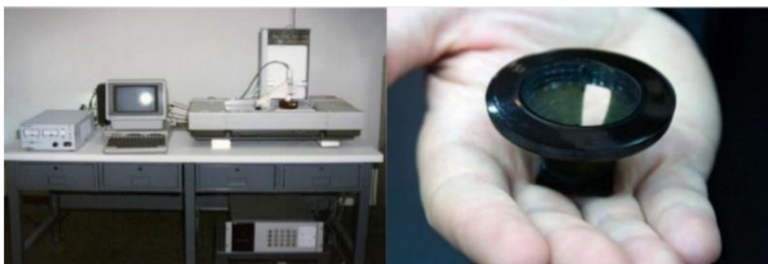
Εικόνα 4: Το πρώτο σύστημα 3D printing (αριστερά), το πρώτο εκτυπωμένο τεμάχιο (δεξιά).
