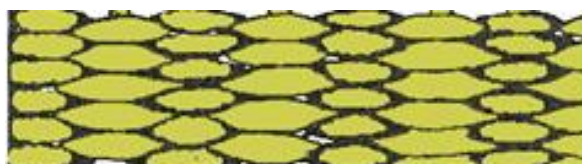
Εικόνα 6 Σχεδιαστική αποτύπωση της απλής ανισομερής ύφανσης όπου επικρατεί το υφάδι (© Αβραμόπουλος, 2021).
