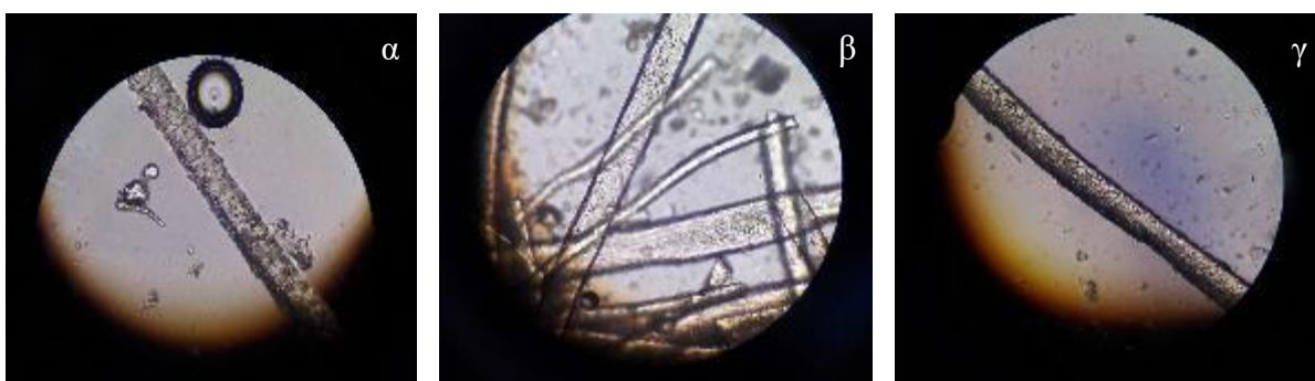
Εικόνα 11α-γ Παρουσίαση ινών όπως εικονίζονται στο οπτικό μικροσκόπιο διερχόμενου φωτός. Είναι εμφανή τα επιθηλιακά κύτταρα που συναντώνται σε ίνες προερχόμενες από τρίχωμα ζώου(© Αβραμόπουλος, 2021).
