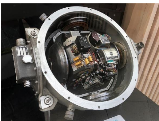
Εικόνα 6: Η συσκευή IMU (Inertial Measurement Unit) που χρησιμοποιήθηκε στο πρόγραμμα Apollo 11
