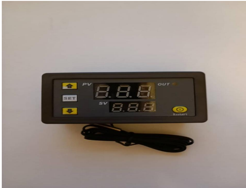
Figure 12: Ψηφιακός θερμοστάτης ελέγχου συμπιεστή W3230
