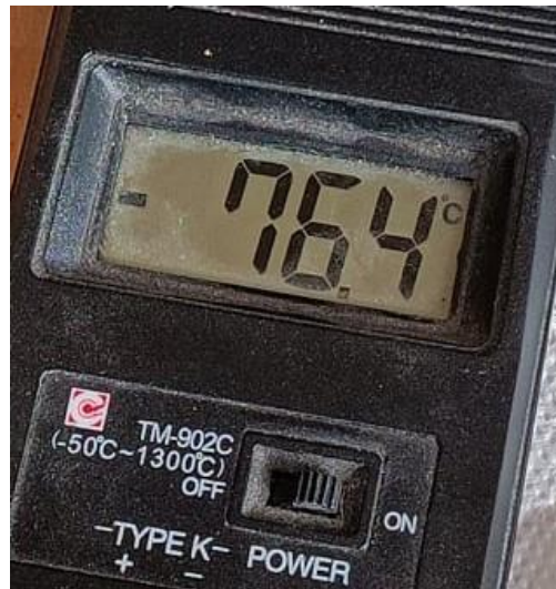
Figure 13: Θερμόμετρο k type με την ένδειξη της θερμοκρασίας 2ου σταδίου
