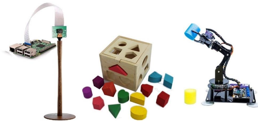
Σχήμα 162: 3-D puzzle και ρομποτικός βραχίονας καθοδηγούμενος από κάμερα Raspberry V2 ελεγχόμενη από μικροεπεξεργαστή Raspberry 3 b+.
