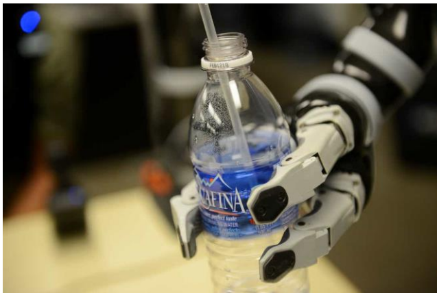
Σχήμα 11: Μηχανικά δάχτυλα με ενσωματωμένους αισθητήρες πίεσης
