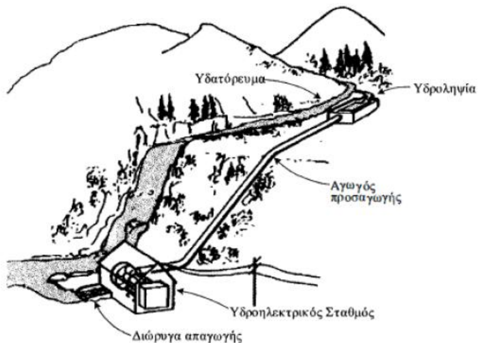
Σχήμα 3.2 Αρχή διαμόρφωσης μικρού ΥΗΕ με κλειστό αγωγό προσαγωγής. [Ε3, Σχήμα 3.3]
