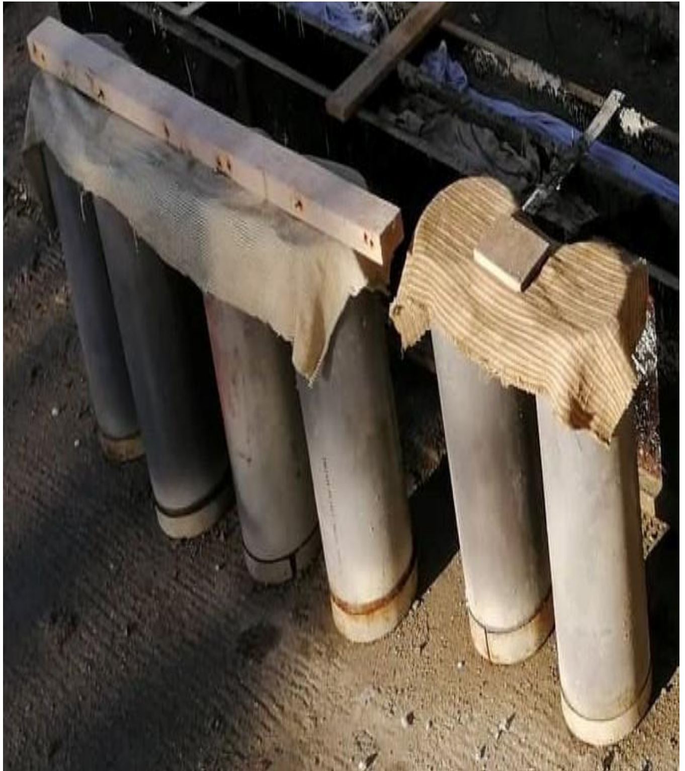
Δοκίμια αμέσως μετά την σκυροδέτησή τους.
