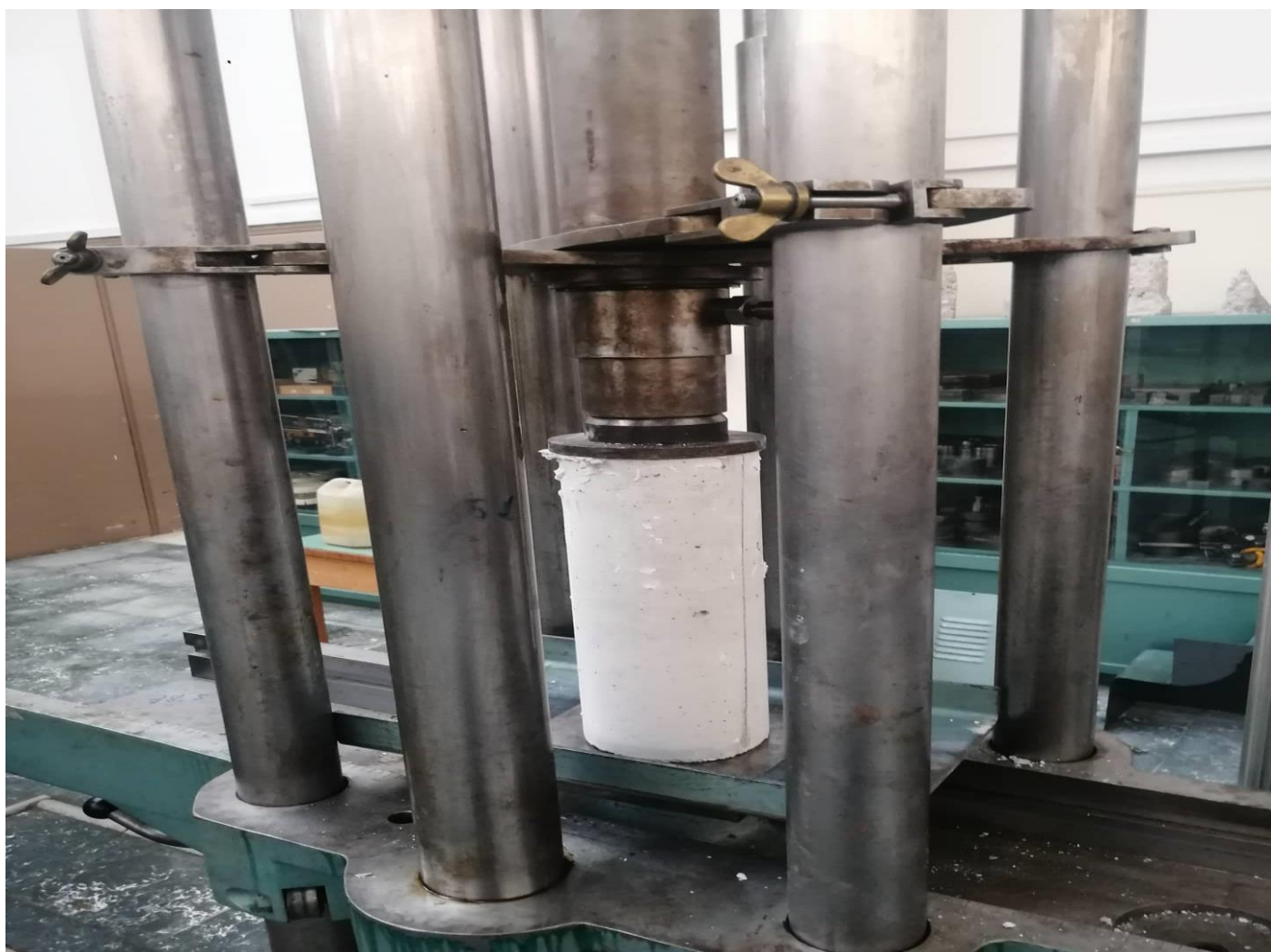
Δοκίμιο που υποβάλλεται σε μονοαξονική θλίψη στη μηχανή
