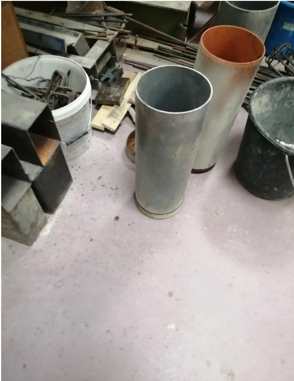
Καλούπια από σωλήνες PVC που χρησιμοποιήθηκαν για την κατασκευή των δοκιμών με μεταλικά καπάκια στο κάτω μέρος.
