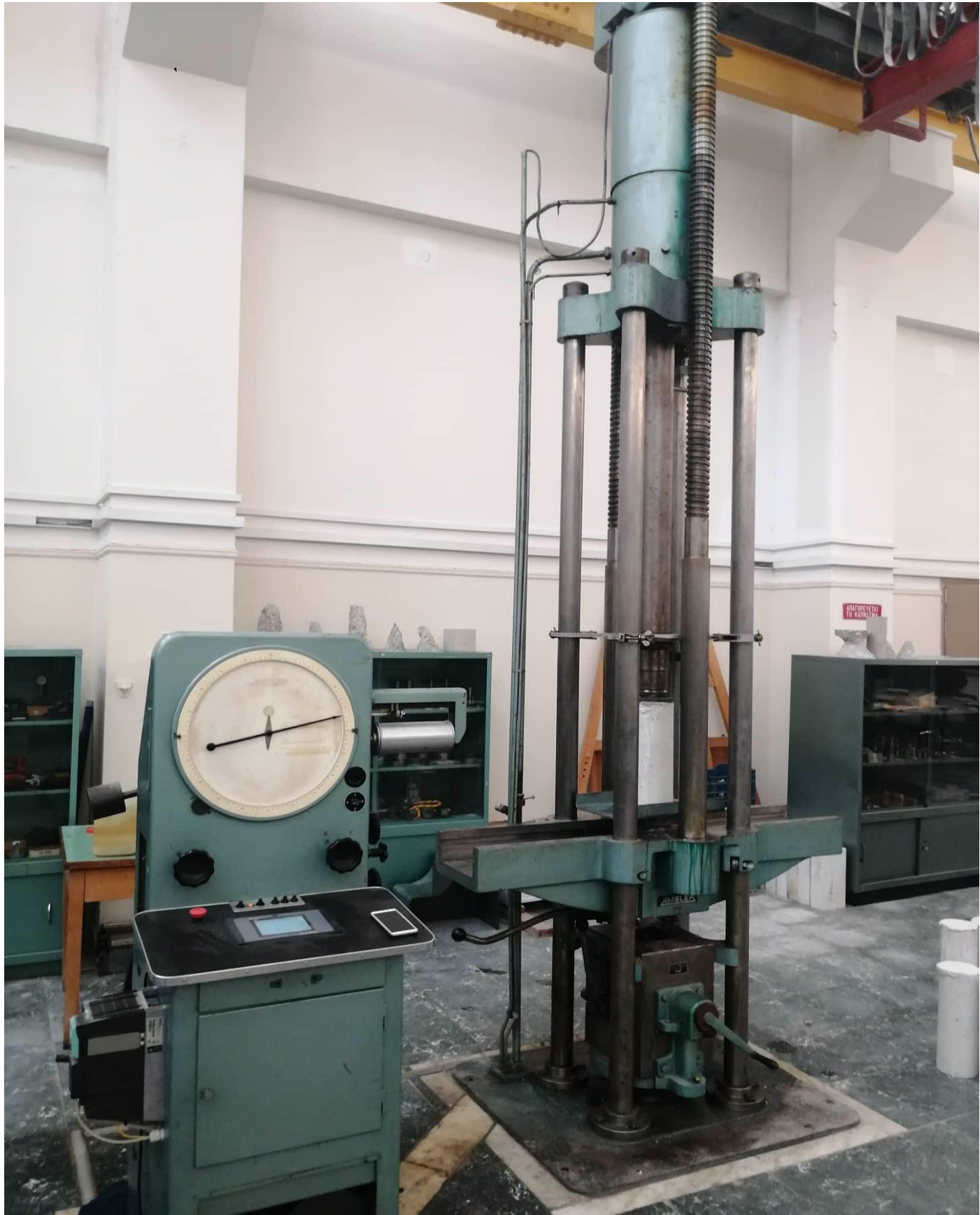
Διάταξη μηχανής μονοαξονικής θλίψης εργαστηρίου αντοχής υλικών Εθνικού Μετσόβιου Πολυτεχνείου.
