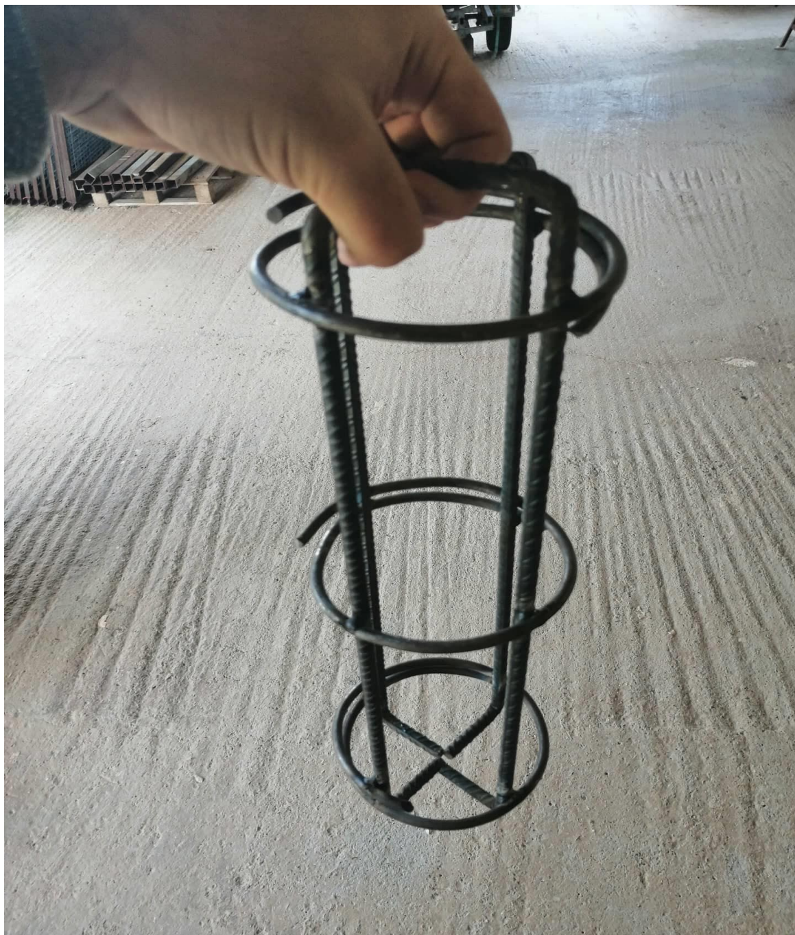
Σκελετός οπλισμού τριών συνδετήρων που χρησιμοποιήθηκε σε δοκίμιο
