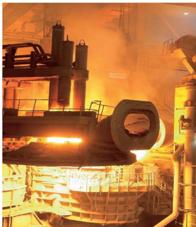
Ηλεκτρικός κλίβανος τόξου(ELECTRIC ARC FURNACE)
