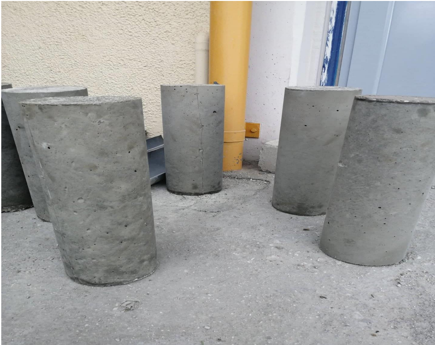
Δοκίμια αμέσως μετά την αφαίρεση των καλουπιών
