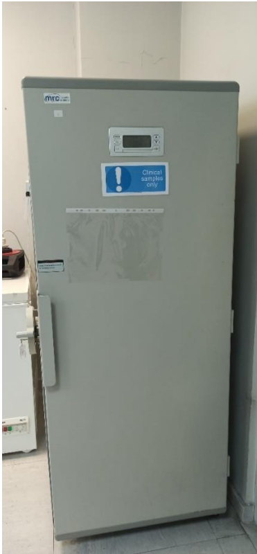
Εικόνα 33 Καταψύκτης βιολογικών υλικών (βαθιά κατάψυξη στους -40^{\circ}\text{C} ) (MRC Laboratory Equipment).
