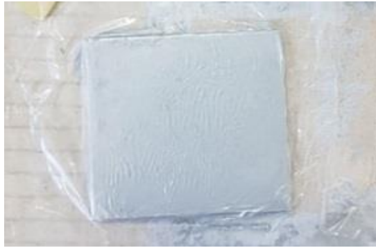
Εικόνα 18. Δοκίμιο Νο 2 μετά την εφαρμογή των αντιδιαβρωτικής επίστρωσης και θερμοπλαστικής επένδυσης, όπως περιγράφεται στο κείμενο.
