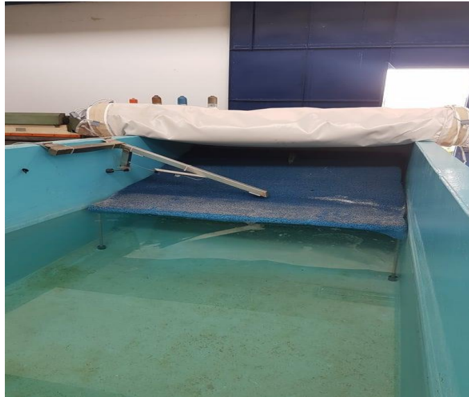
Εικόνα 12. Ο αποσβεστήρας κυμάτων της δεξαμενής και η βιορύπανση στον πυθμένα.
