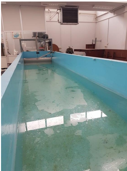
Εικόνα 11. Βιορύπανση στην επιφάνεια και στον πυθμένα της δεξαμενής και στο βάθος ο μηχανισμός του κυματιστήρα.
