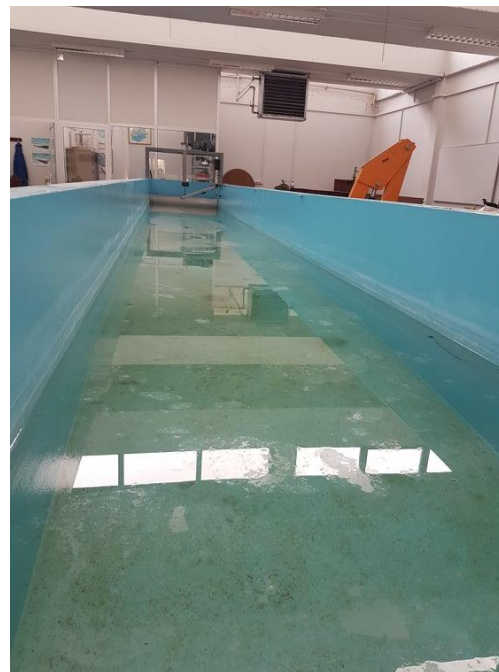
Εικόνα 11. Βιορύπανση στην επιφάνεια και στον πυθμένα της δεξαμενής και στο βάθος ο μηχανισμός του κυματιστήρα.
