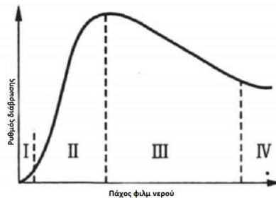
Σχήμα 3. Σχέση μεταξύ του πάχους υμένα νερού με το ρυθμό διάβρωσης στην ατμόσφαιρα [1].
