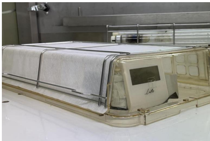
Εικόνα 11: Filter top με ενσωματωμένο αισθητήρα θερμοκρασίας και υγρασίας.
