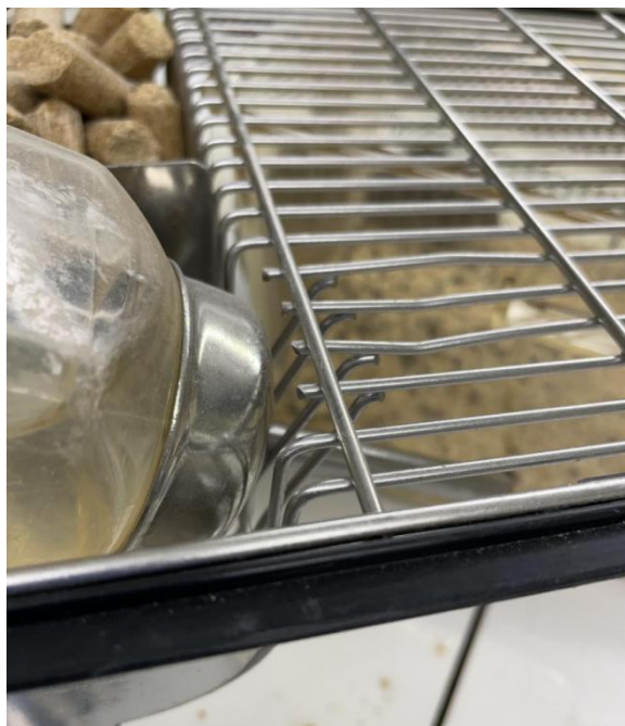
Εικόνα 12: Τροποποιημένη σχάρα του κλωβού, με σκοπό την τοποθέτηση του μπουκαλιού νερού σε ανυψωμένη θέση.
