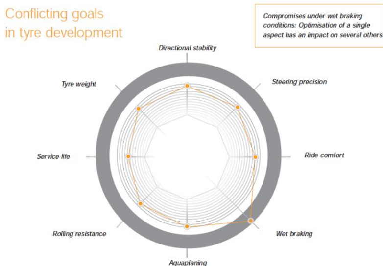
Εικόνα 4: Αντικρουόμενοι στόχοι στην ανάπτυξη ελαστικών [3]
