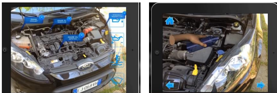
Εικόνα 8-3 Εφαρμογή της AR στην επισκευή αυτοκίνητου - (πηγή:120)
