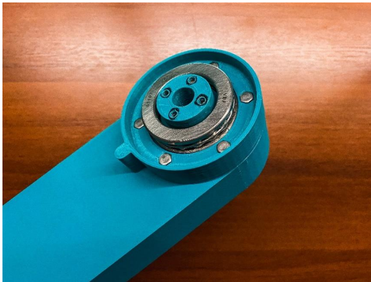
Εικόνα 24: Εγκατάσταση 2 ης Άρθρωσης Στον 2 ο Σύνδεσμο.
