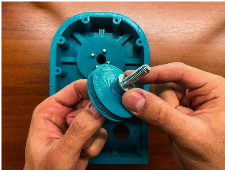
Εικόνα 18: Συναρμολόγηση Γραναζιού Μείωσης.
