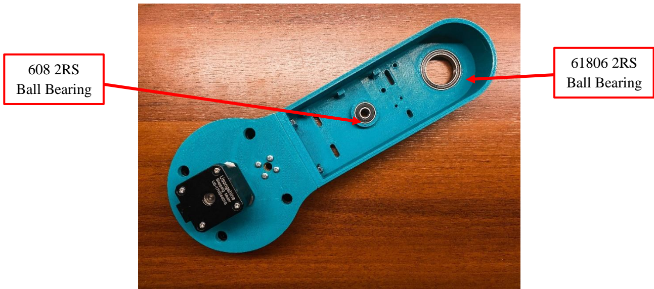
Εικόνα 22: Τοποθέτηση 1ου Συνδέσμου στην Βάση του
