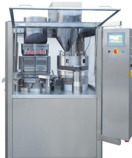
Εικόνα 16: Μηχανή Παραγωγής κάψουλας[8]
