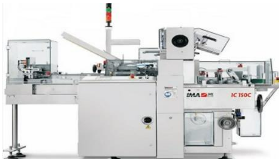
Εικόνα 18: Μηχανή Συσκευασίας Ταμπλέτας[19]
