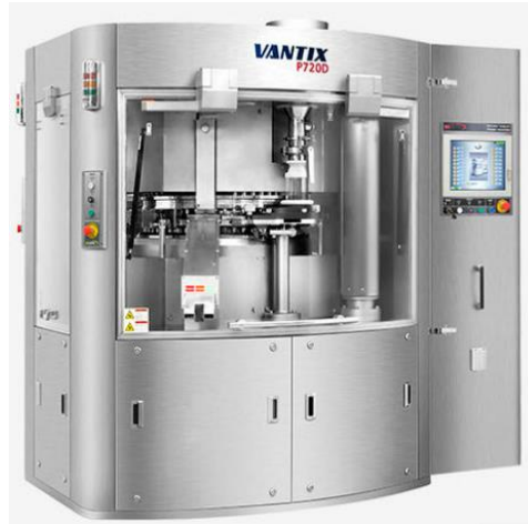
Εικόνα 15: Μηχανή Παραγωγής δισκίου[9]
