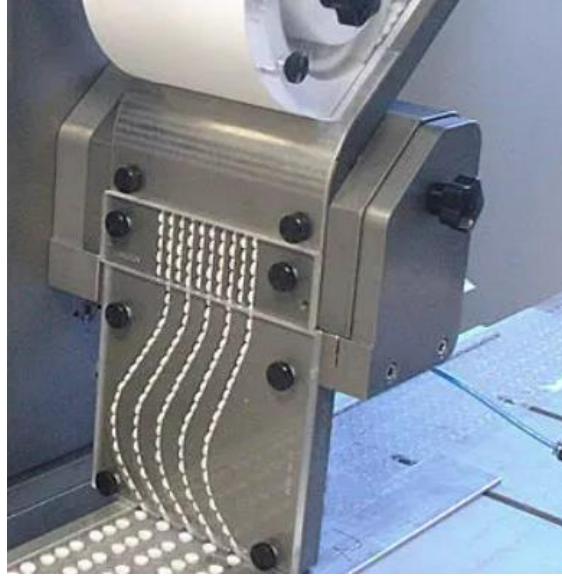
Εικόνα 55: Απλός τροφοδότης δισκίου
