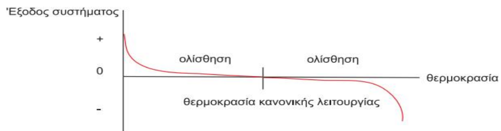
Εικόνα 21 Ολίσθηση λόγω θερμοκρασίας (ΚΑΛΟΒΡΕΚΤΗΣ ΙΙΙ. ΚΩΝΣΤΑΝΤΙΝΟΣ, 2019)
