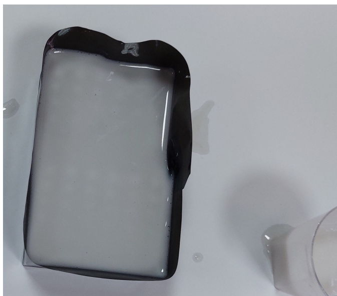
Εικόνα 25: Ομοίωμα 1 το οποίο έχει καλυφθεί με το μείγμα ρητίνης-υδροξυαπατίτη.
