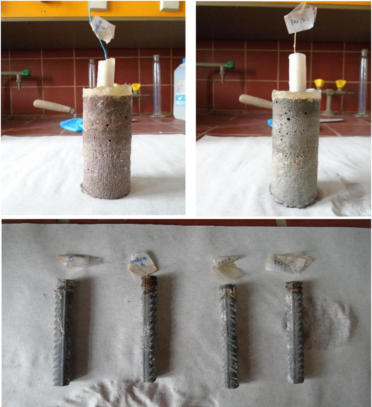
Εικόνα 9.3. Τα δοκίμια πριν την αφαίρεση του σκυροδέματος, και οι οπλισμοί πριν την ζύγιση
