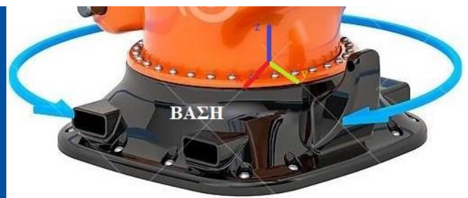
Εικόνα 6.3: Βάση με στρεπτική άρθρωση για Παρεκτροπή 360° του Ρομποτικού Βραχίονα
