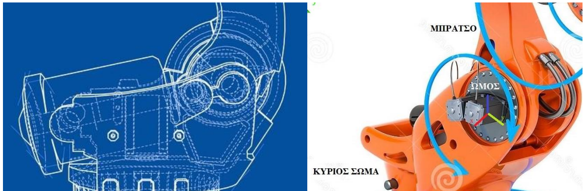
Εικόνα 6.4: Ώμος με Περιστροφική Αρθρωση για Κάμψη του Μπράτσου
