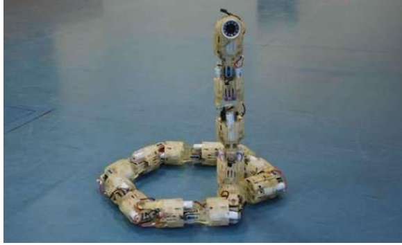
Εικόνα 2.14: Ρομποτικό Φίδι για χρήση στις Ισραηλινές Δυνάμεις με την ικανότητα να μπορεί να λειτουργεί ακόμα και αν καταστραφούν μερικά κομμάτια του
