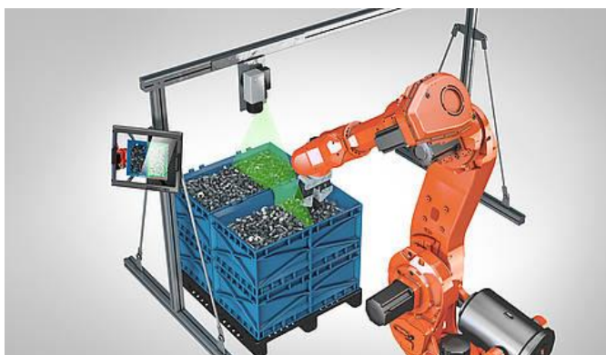
Εικόνα 9.6: Ταξινόμηση Εξαρτημάτων με τη βοήθεια της Υπολογιστικής Όρασης και Αναγνώρισης Μοτίβων
