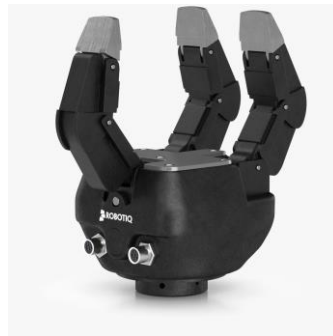
Εικόνα 7.12: Αρπάγη 3 Δακτύλων με Προσαρμογή τους γύρω από το αντικείμενο
