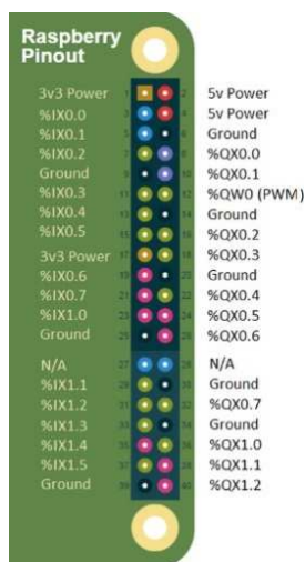
Εικόνα 2.3 : OpenPLC Raspberry Pi GPIO map.
