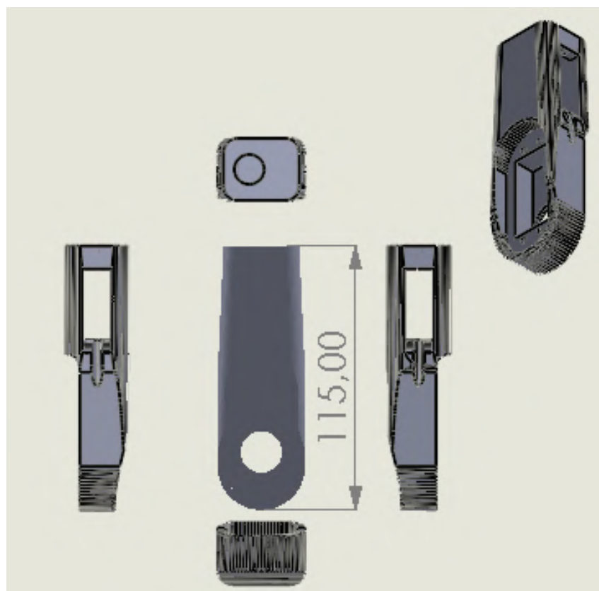
ΕΙΚΟΝΑ 3.3.4: 3D μοντέλο του συνδέσμου μεταξύ της 3ης και 4ης άρθρωσης
