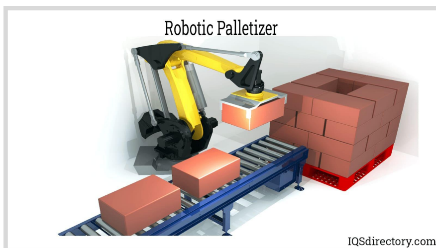
ΕΙΚΟΝΑ 2.2.19: Χρήση ρομποτικού βραχίονα για παλετοποίηση
