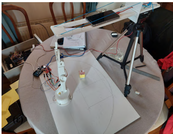
ΕΙΚΟΝΑ 3.6.3: (α)(β) Διαγράμμιση του χώρου εργασίας, (γ)(δ) Κατασκευή της βάσης για την κάμερα, (ε)(ζ) Τελική μορφή του ολοκληρωμένου ρομποτικού συστήματος
