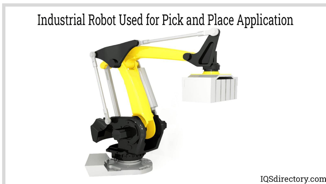
ΕΙΚΟΝΑ 2.2.11: Χρήση ρομποτικού βραχίονα για pick and place εργασίες
