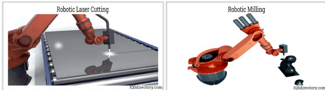
ΕΙΚΟΝΑ 2.2.18: Χρήση ρομποτικού βραχίονα για επεξεργασία και για κοπή μετάλλου
