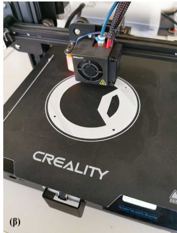
ΕΙΚΟΝΑ 3.4.4: (α) Ο 3D εκτοπωτής του εργαστηρίου Crealty Cr-20 pro, (β) Εκτόπωση της βάσης του ρομποτικού βραχίονα
