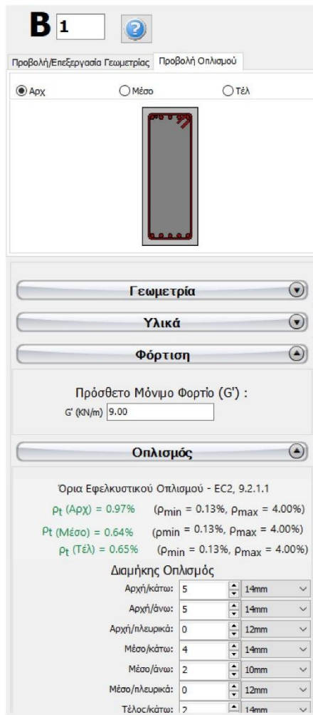
Σχήμα 6.6 Εισαγωγή στοιχείων για τη δοκό
