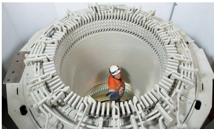
Σχήμα 1.20: Συνδέσεις περιέλιξης στάτη σύγχρονης γεννήτριας Υ.Η.Σ. [Ξ21, Fig. 1, page 1]
