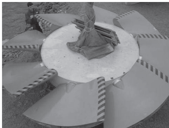
Σχήμα 1.17: Εγκατάσταση και Δρομέας Στρόβιλου Πολύ Μικρού Ύψους Πτώσης (VLH) [E5, Fig. 12.4 page 309]
