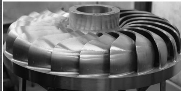
Σχήμα 1.14: Δρομέας Στροβίλου Turgo [Ξ5, Fig. 10.7, page 253]
