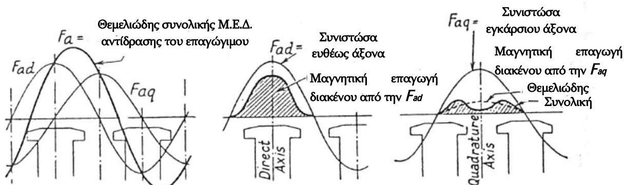
α) Συνιστώσες της αντίδρασης του επαγωγίμου β) Αντίδραση ευθέως άξονα γ) Αντίδραση εγκάρσιου άξονα
