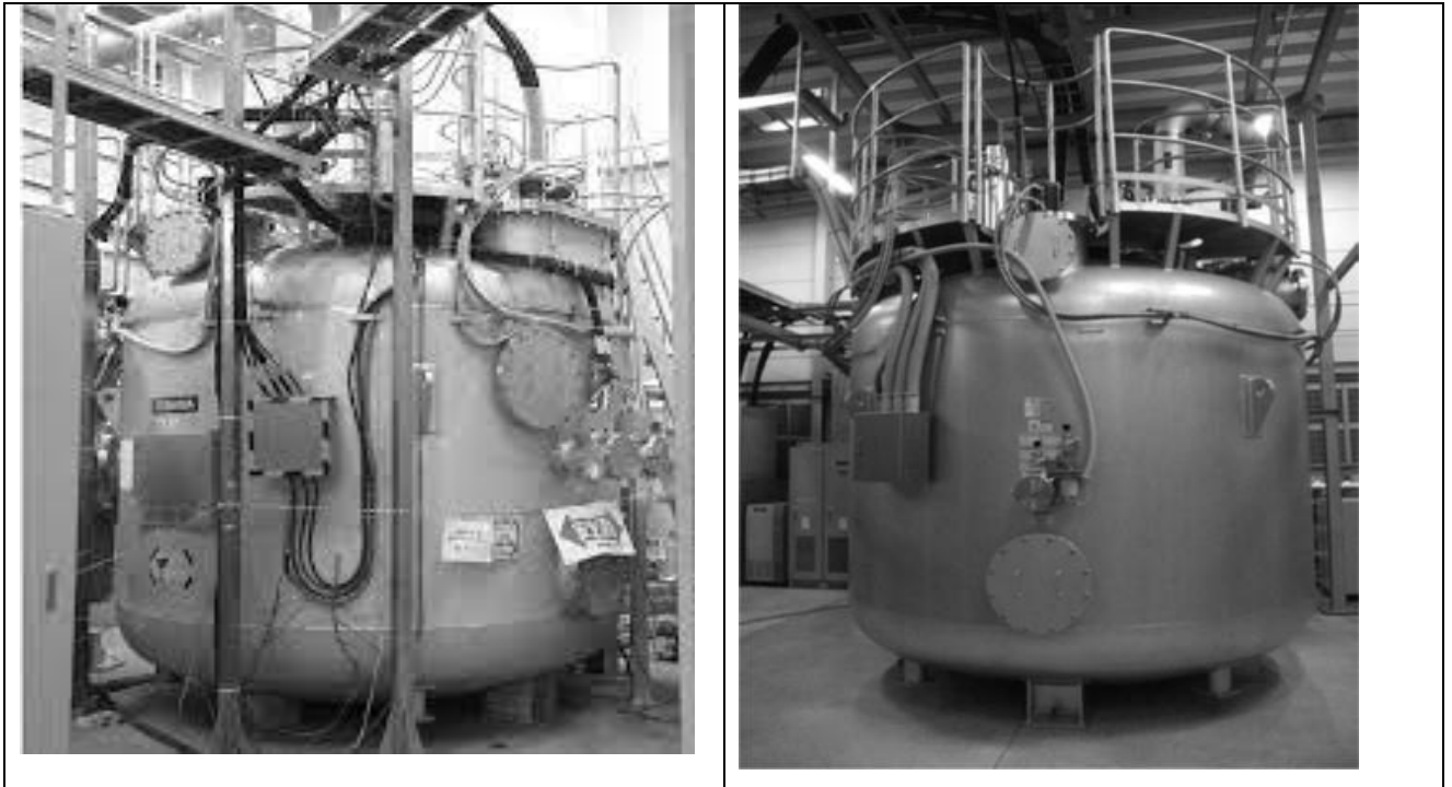
Εικόνα 4.2- Φωτογραφίες του κρυοστάτη για το πρωτότυπο SMES 10 MVA/20 MJ (πηγή :
