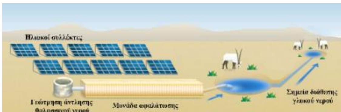
Εικ.46-Υβριδικός σταθμός ο οποίος χρησιμοποιείται για την τροφοδότηση μονάδας αφαλάτωσης
