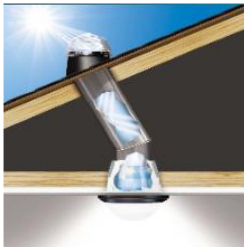
Εικ.34- Φωτοσωλήνες με κάτοπτρα και φακούς οι οποίοι διαθλούν το φως και το πολλαπλασιάζουν.
