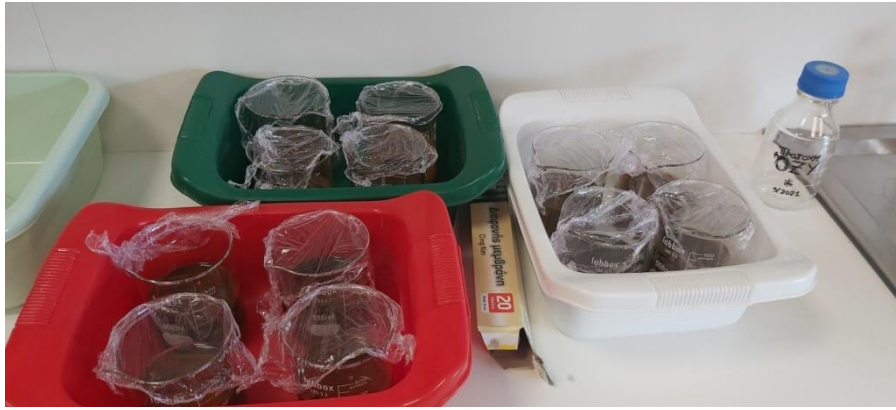
Εικ.4.5: Τα δοχεία με τα δοκίμια για τον προσδιορισμό της απώλειας μάζας.
