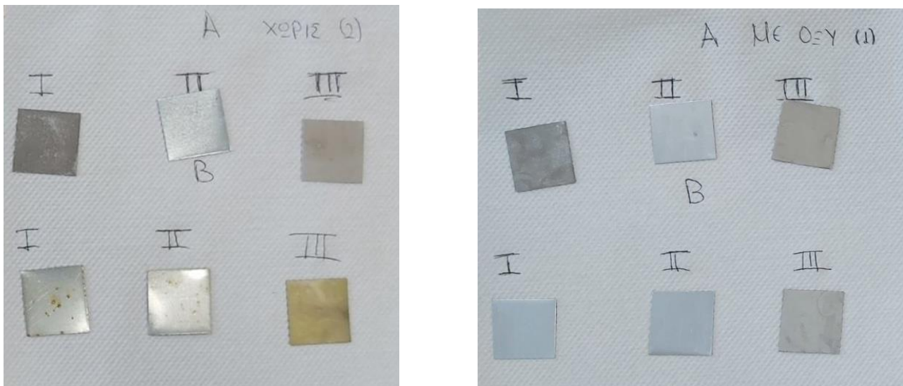
Εικ.4.7: Δοκίμια μετά από εμβάπτιση σε: διάλυμα αναφοράς (I), σε διάλυμα Κροκίνης (II), σε διάλυμα Αλφαζουρίνης (III) μετά τον καθαρισμό τους με νερό (αριστερά) ή με οξύ (δεξιά).
