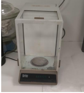
Εικ.4.3: Ο αναλυτικός ζυγός με τον οποίο πραγματοποιήθηκαν οι μετρήσεις μάζας των δοκιμίων.
