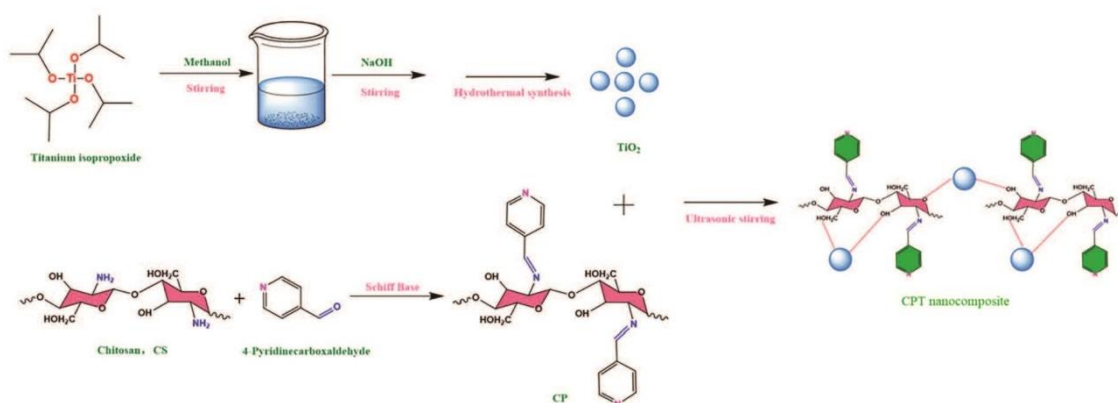
Σχήμα 3.38: Σύνθεση των TiO_2 , CP (συζευγμένο πολυμερές), titanium dioxide (CPT) nanocomposite. (Lai, 2021)
