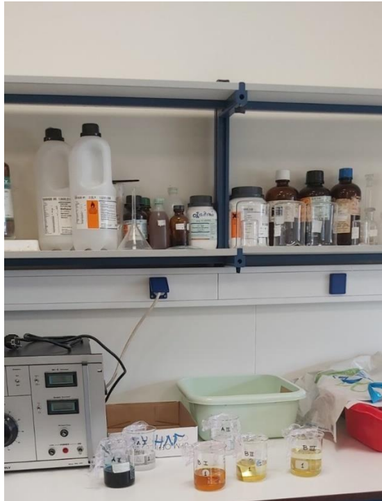
Εικ.4.4: Τα δοχεία με τα διαλύματα, όπου πραγματοποιήθηκε η εμφάνιση των δοκιμίων αλουμινίου.
