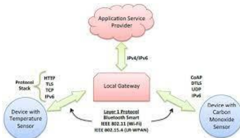
Εικόνα 3.3: Μοντέλο επικοινωνίας συσκευή με ενδιάμεσο κόμβο gateway
