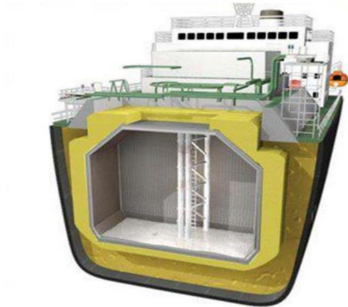
Εικ. 1.7: Δεξαμενή LNG πλοίου από χάλυβα[7]
