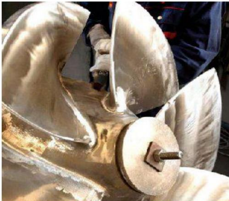
Εικ. 1.8: Έλικα πλοίου από ωστενιτικό χάλυβα για πλοία που πλέουν σε πάγο[8]
