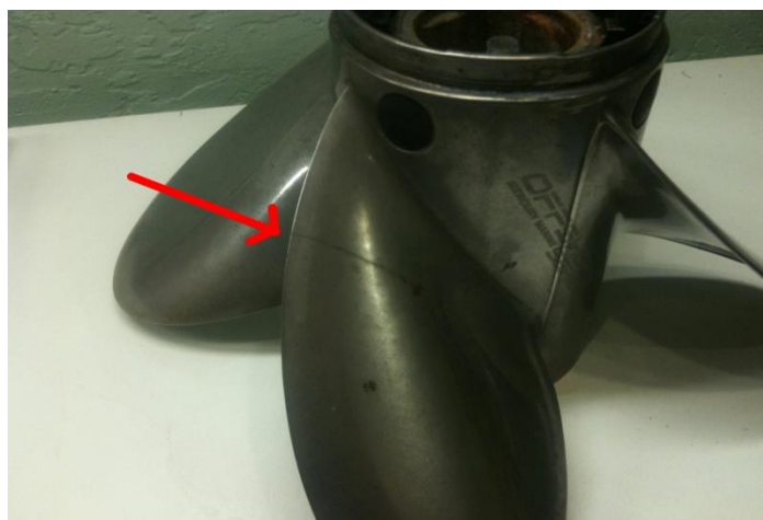
Εικ. 2.2: Ρωγμή προπέλας[10]
