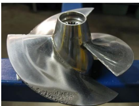
Εικ. 2.16: Διάβρωση φθοράς λόγω ροής σε προπέλα πλοίου [21]
