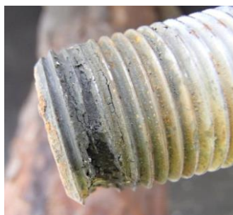
Εικ. 2.11: Σπηλαιώδης διάβρωση σε βίδα χρησιμοποιούμενη σε άξονα μετάδοσης
