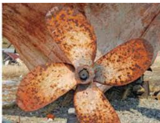
Εικ. 2.7: Διάβρωση προπέλας [14]
