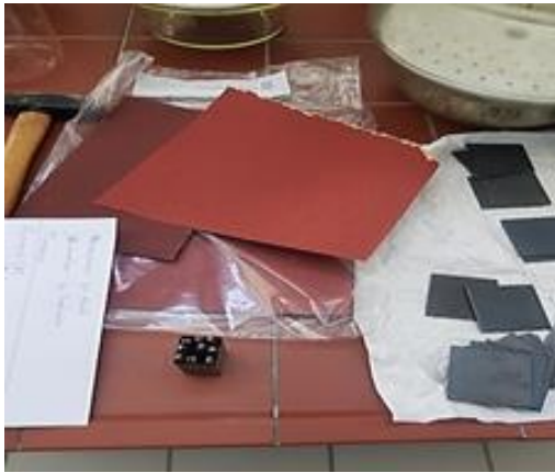
Εικ. 4.9: Δοκίμια χάλυβα, επιλογή και αρίθμηση
