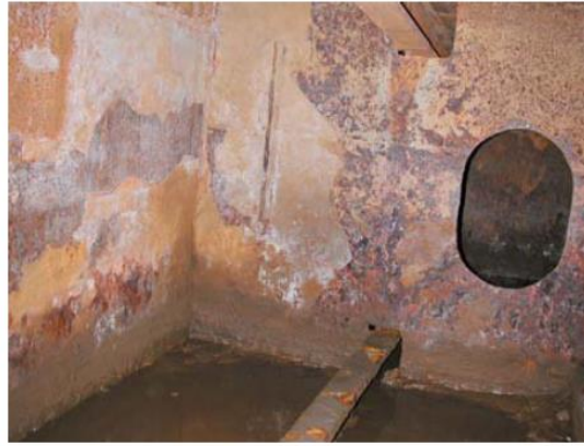
Εικ. 3.3: Δεξαμενή πλοίου μετά από χρήση 5 χρόνων[27]
