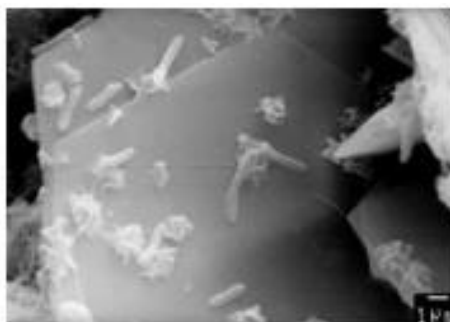
Εικ. 2.19: Βακτηριακή διάβρωση σε χαλύβδινη επιφάνεια εκτεθειμένη σε θαλάσσιο περιβάλλον [24]
