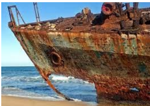
Εικ. 2.6: Διάβρωση στο θαλάσσιο περιβάλλον [13]
