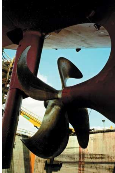
Εικόνα 40. Έλικα Τύπου Kappel τοποθετημένη στο φορτηγό πλοίου M/T Nordamerika (Πηγή: www.mek.dtu.dk/KAPPEL_Propeller ).
