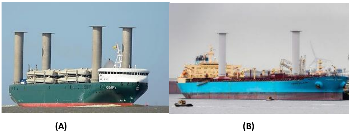
Εικόνα 22. E-ship1 (A), και Maersk Pelican με εγκατεστημένους ρότορες (B) [66].
