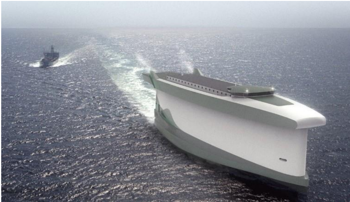
Εικόνα 27. Αναπαράσταση του υβριδικού συστήματος « Vindskip » της εταιρείας Lade AS με τις αεροτομές στον σχεδιασμό της γάστρας [76].
