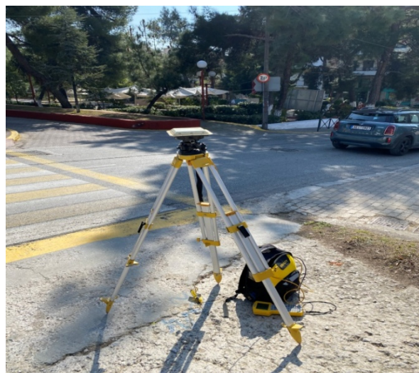
Εικόνα 38: Δέκτης GNSS trimble 4700 οριζοντιωμένος στην στάση S2.
