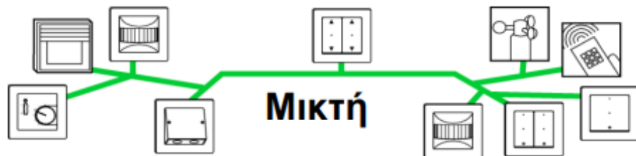
Εικόνα 4.10: Τοπολογία δένδρου, τύπου αστέρα-διαύλου
