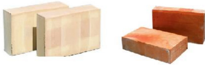
Εικόνα 13: Διαφορετικά είδη από συμπαγείς οπτόπλινθους
