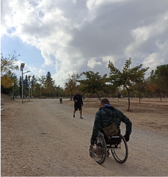
Εικόνα 3.23 Δυσκολία κίνησης στον χώρο λόγω των δαπέδων, τα οποία όμως εξυπηρετούν σε άλλες χρήσεις, όπως την διάχυση του νερού στο έδαφος, την ασφαλέστερη άθληση και την αισθητική σύνδεση με την φύση. (προσωπικό αρχείο 05/11/22)
