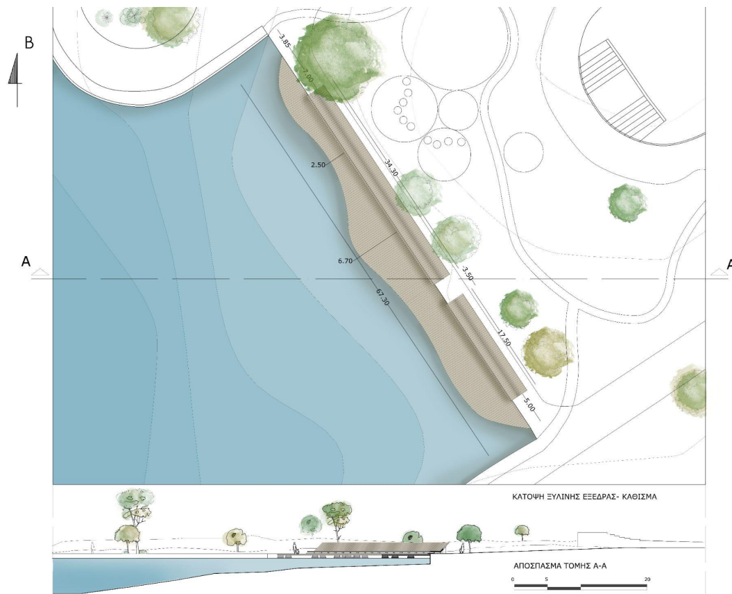
Εικόνα 4.6 Κάτοψη και μέρος της Τομής Α-Α για την Ξύλινη εξέδρα - κάθισμα (Δημιουργία γράφουσας).
