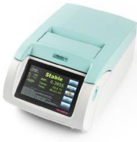
Εικόνα 14 - Μετρητής ενεργότητας νερού – Labtouch-aw της εταιρείας Novasina
