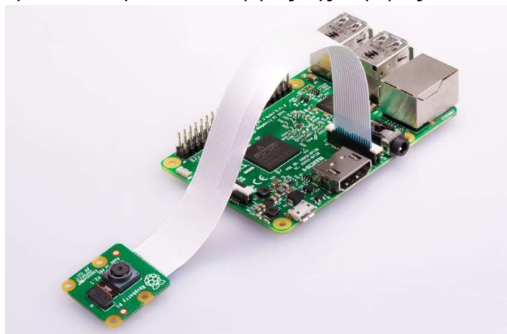
Εικόνα 4.3 : Η Pi Camera συνδεδεμένη με το Raspberry Pi μέσω του ειδικού καλωδίου - θύρας
