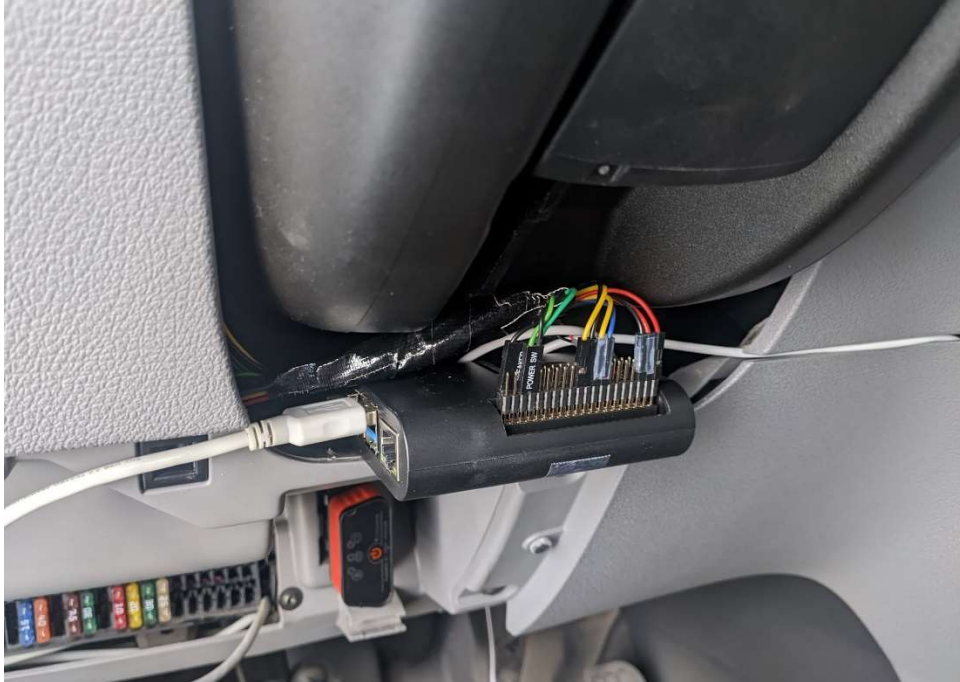
Εικόνα 4.20: Τοποθέτηση Raspberry Pi
