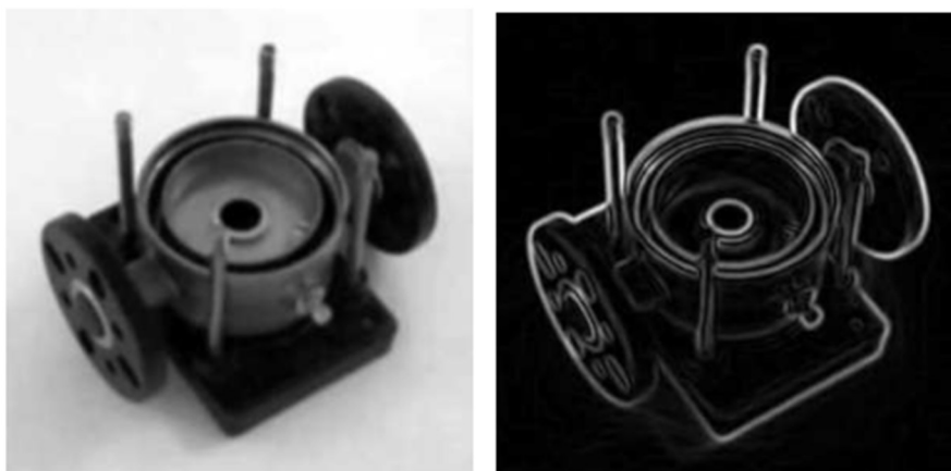
Εικόνα 3.2: Εικόνα μετά την εξομάλυνση Gauss (αριστερά), Εικόνα με εύρεση κλίσης (δεξιά)
