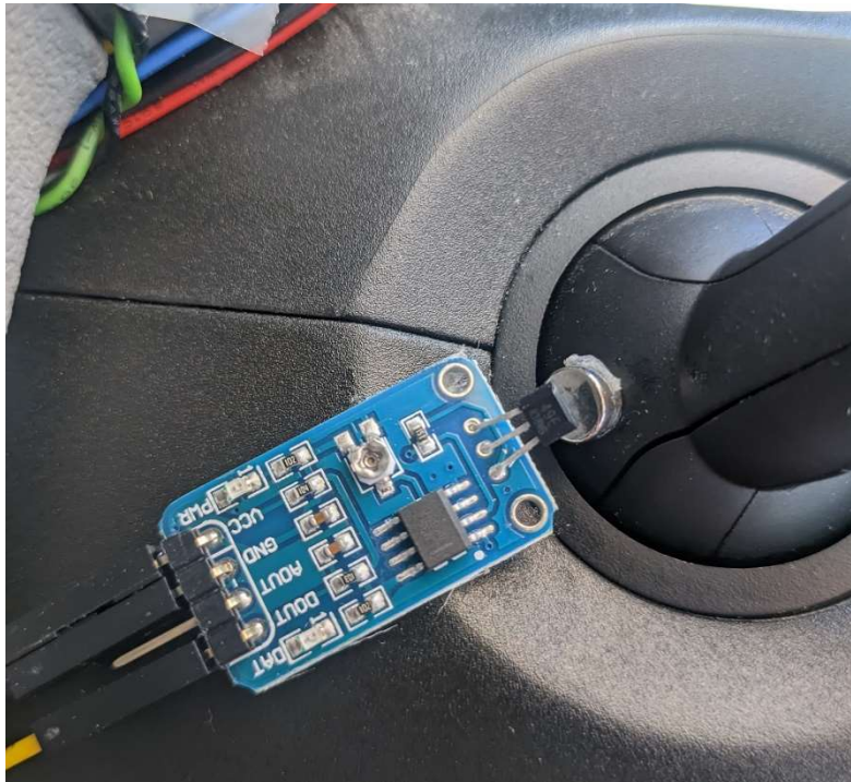
Εικόνα 4.18 : Τοποθέτηση Hall Effect αισθητήρα
