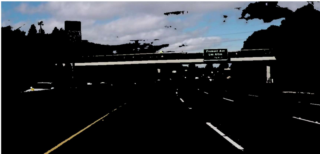
Εικόνα 3.7 : Παράδειγμα απομόνωσης των διαχωριστικών γραμμών της λωρίδας κυκλοφορίας από τον δρόμο
