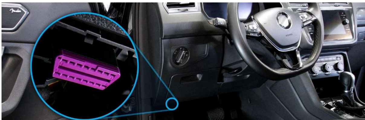
Εικόνα 4.6 : Παράδειγμα θέσης θύρας OBDII στην καμπίνα αυτοκινήτου
