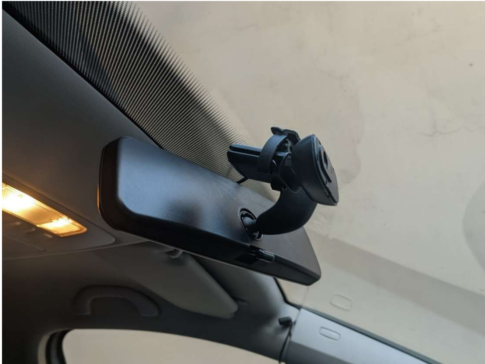
Εικόνα 4.16 : Παράδειγμα τοποθέτησης της κάμερας πίσω από τον μεσαίο καθρέφτη
