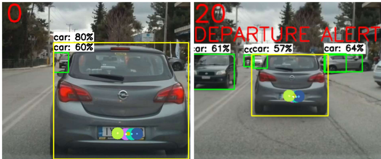
Εικόνα 3.25: Παραδείγματα δυο διαδοχικών στιγμιότυπων προειδοποίησης του οδηγού για εκκίνηση προπορευόμενου οχήματος με χρήση τεσσάρων σημαντικών σημείων
