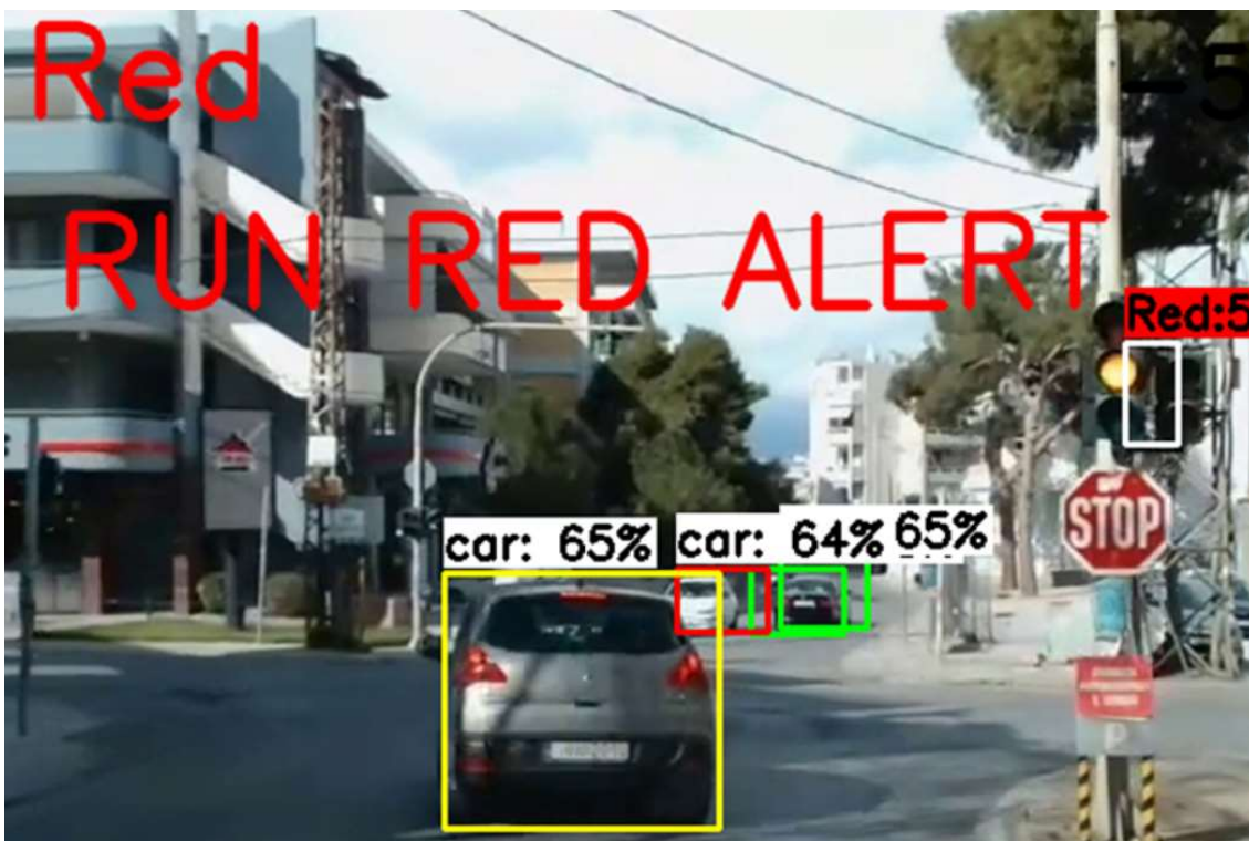
Εικόνα 3.37: Παραδείγματα δυο διαδοχικών στιγμιότυπων προειδοποίησης του οδηγού για επικείμενη παραβίαση ερυθρού σηματοδότη
