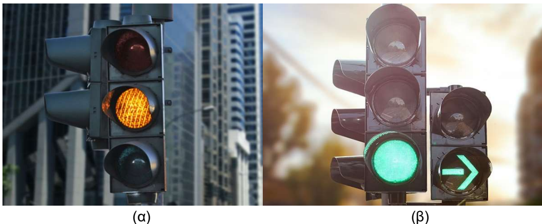
Εικόνα 3.26 : (α) Παράδειγμα μεμονωμένου (β) Παράδειγμα διπλού σηματοδότη (δυο σηματοδοτών που αφορούν διαφορετικές κατευθύνσεις)
